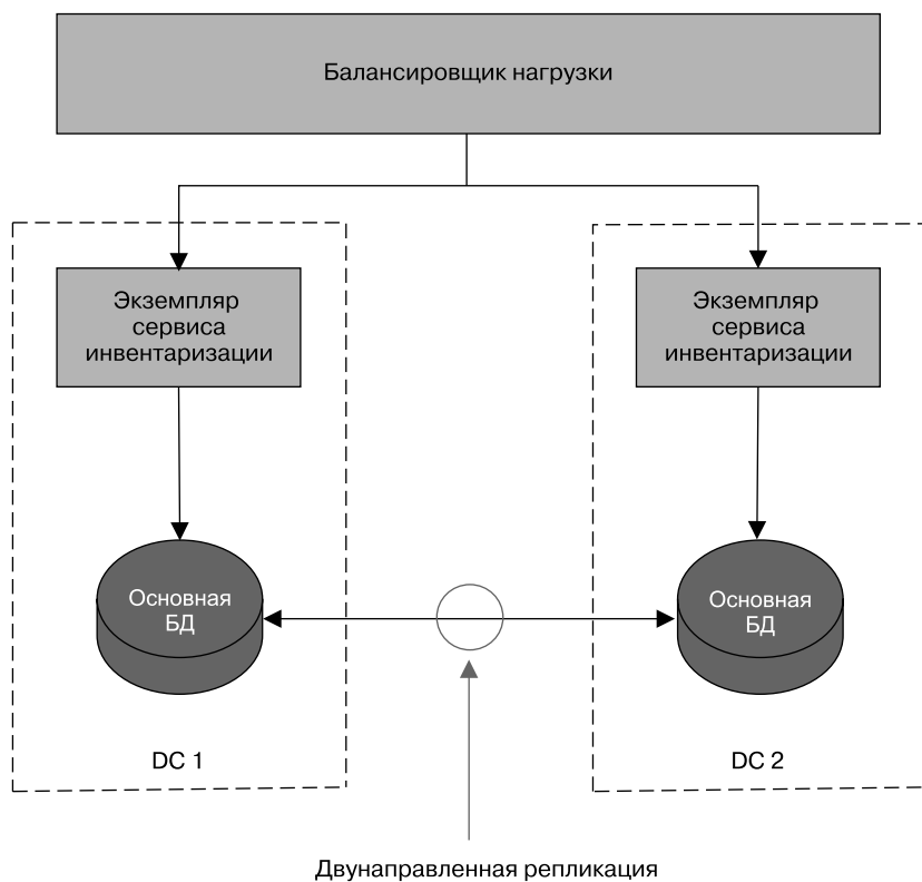
Рис. 11.8. Использование репликации двух основных баз для распределения данных между двумя узлами баз данных
