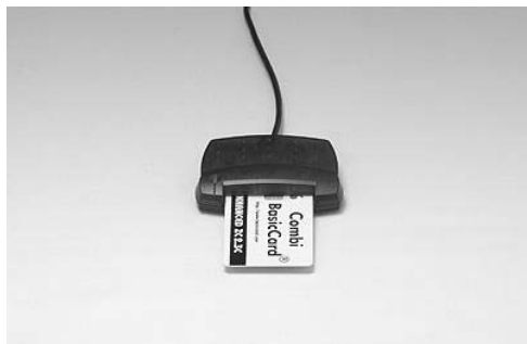
Рис. 4.3. Смарт-карта и устройство для ее чтения
