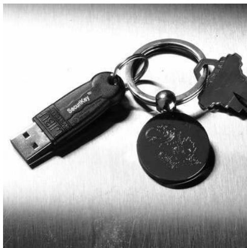
Рис. 4.4. Смарт-карта SecuriKey в виде USB-ключа
