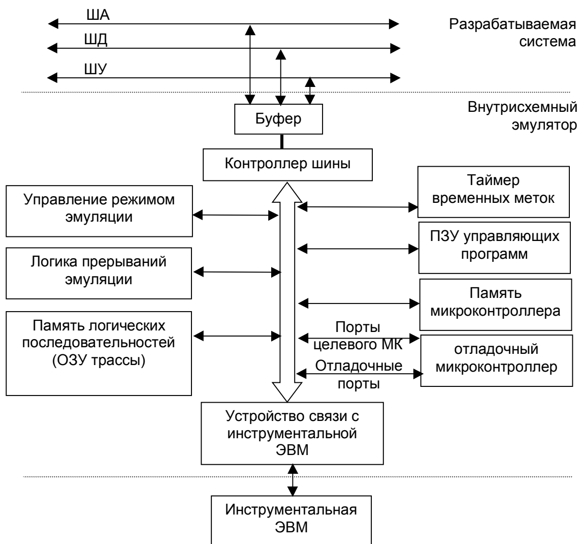
Рис. 4-21. Устройство внутрисхемного эмулятора.
