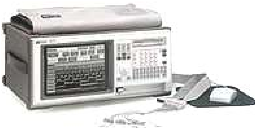
Рис. 4-19. Внешний вид логического анализатора.
