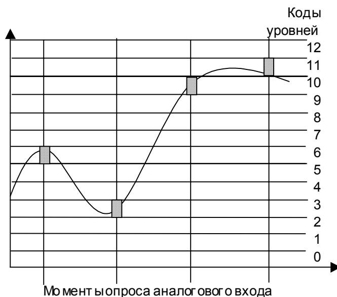
Рис. 1-16. Принцип аналого-цифрового преобразования.
