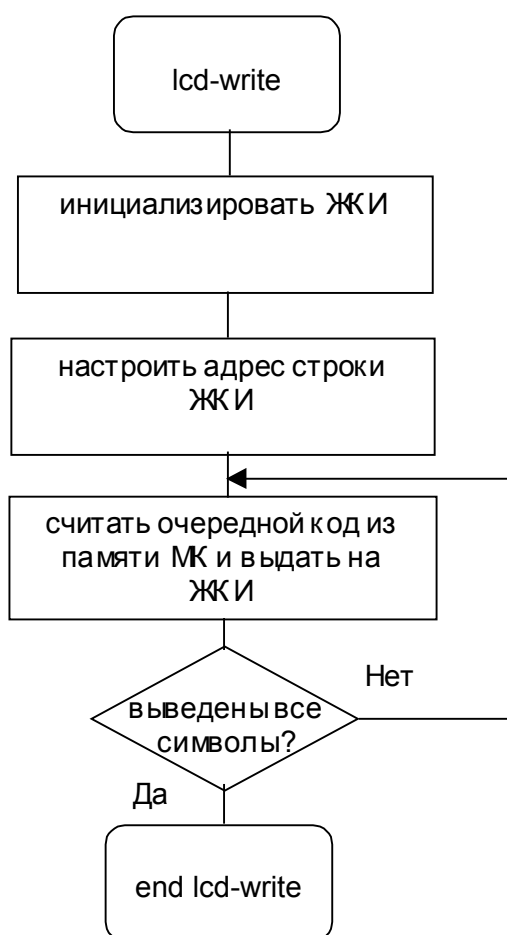
Рис. 6-15. Схема программы вывода информации на ЖКИ.
