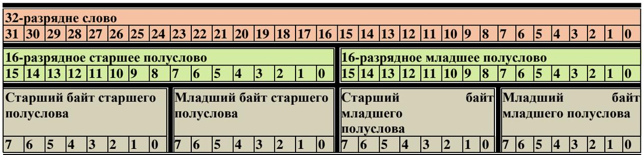
Рис. 6.2 Порядок расположения бит в слове
