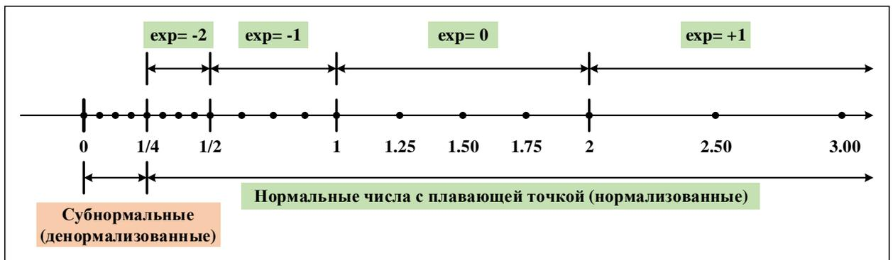
Рис. 19.2 Пример числовой шкалы 6-битовых чисел с плавающей точкой
