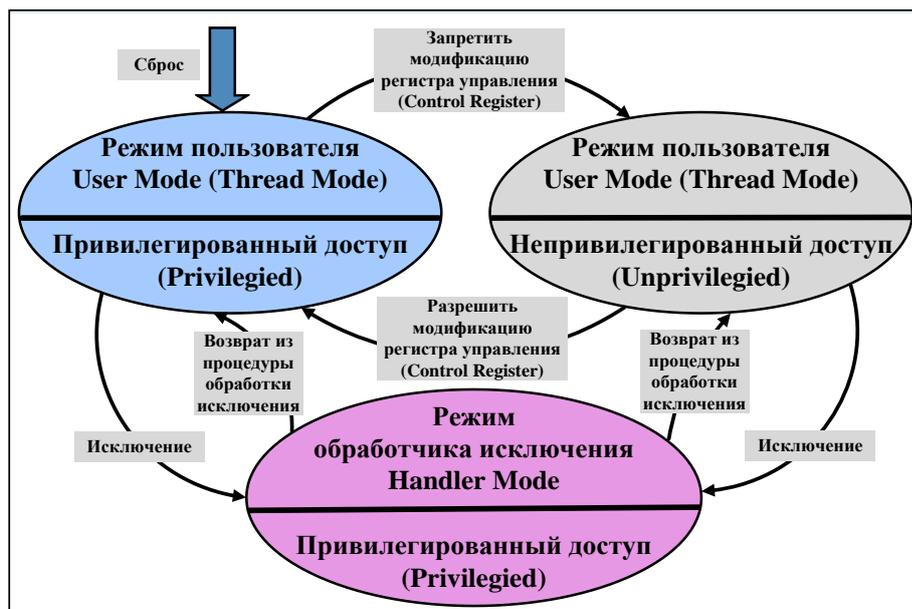
Рис. 5.2 Режимы работы процессоров Cortex-M
