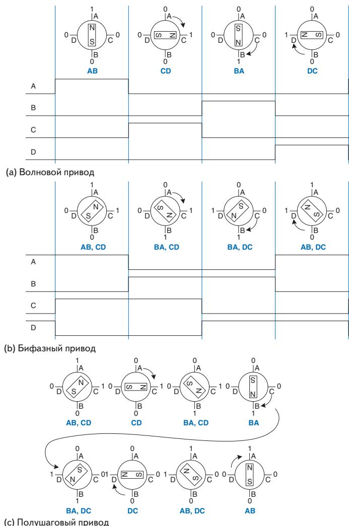
Рис. 4.41. Биполярный двигатель
