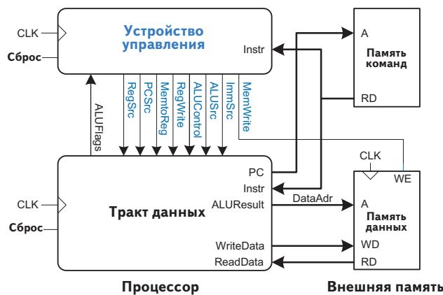
**Рис. 2.59. Подключение однотактного процессора к внешней памяти**
