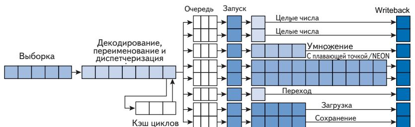
Рис. 2.72. Блок-схемы процессоров Cortex-A7 и Cortex-A15
