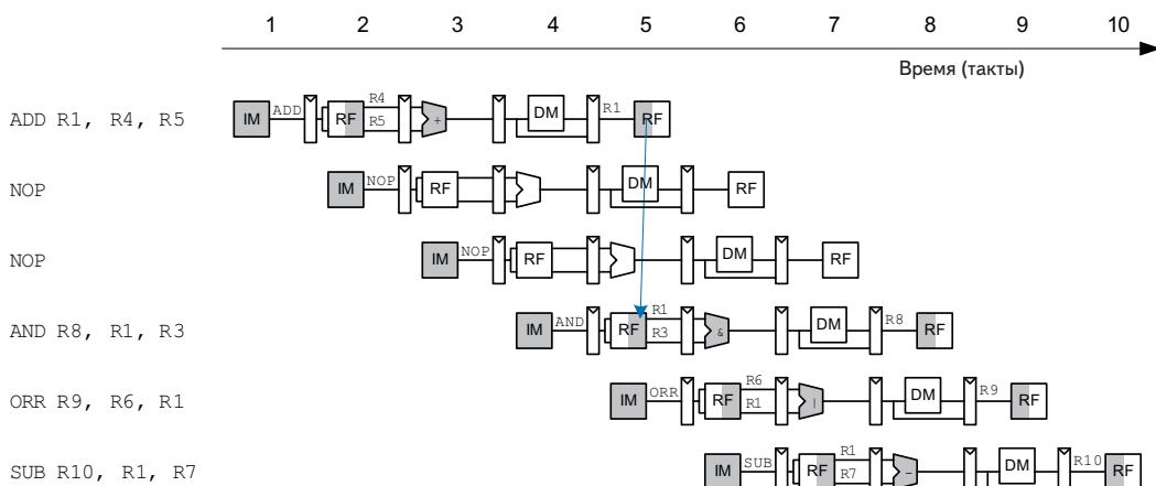
**Рис. 2.49. Разрешение конфликтов с помощью вставки NOP**
