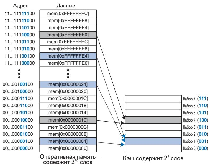
**Рис. 3.5. Отображение оперативной памяти на кэш прямого отображения**
