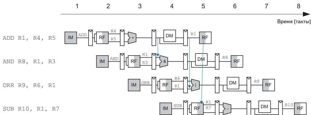
**Рис. 2.50. Абстрактная диаграмма конвейера, иллюстрирующая прорасывание**
