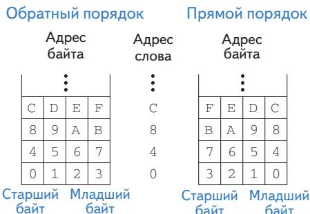
**Рис. 1.2. Адресация данных с прямым и обратным порядком байтов**
