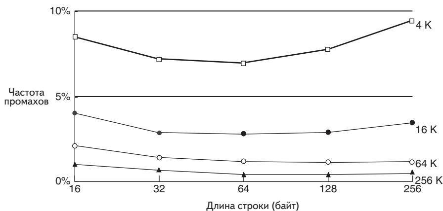
**Рис. 3.18. Зависимость частоты промахов от длины строки и размера кэша на teste SPEC92**
