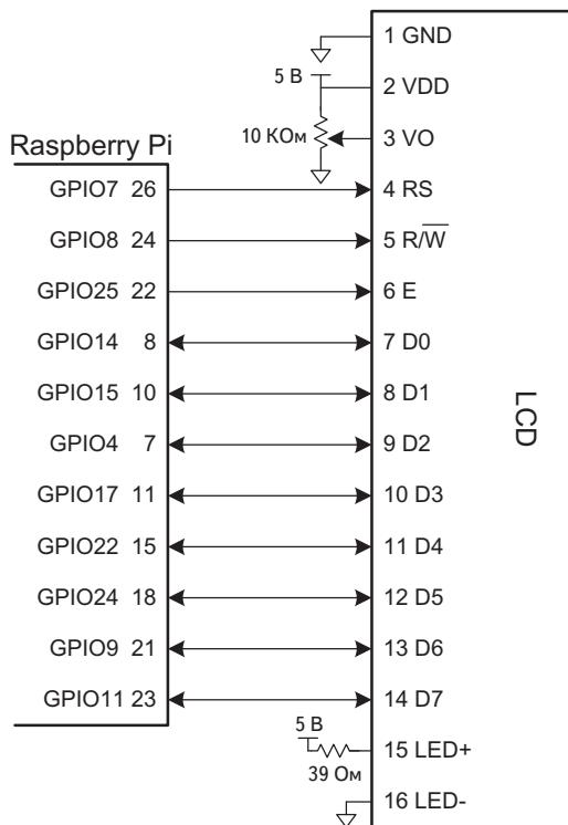
**Рис. 4.25. Подключение ЖК-дисплея при помощи параллельного интерфейса**
