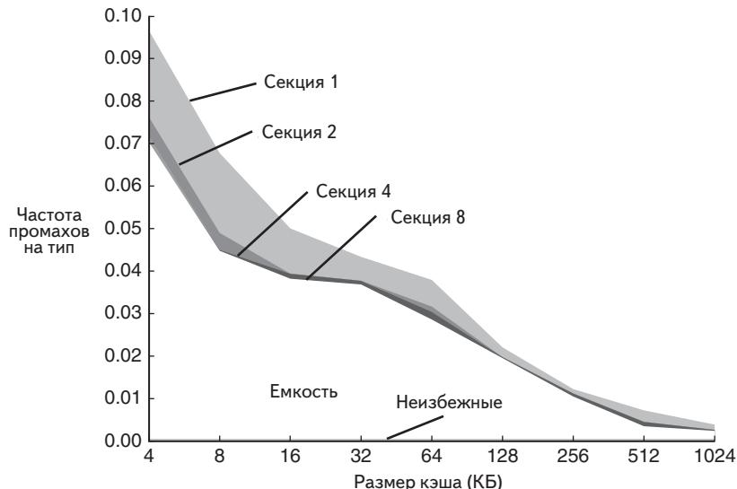
**Рис. 3.17. Зависимость частоты промахов от размера и ассоциативности кэша на teste SPEC2000**
