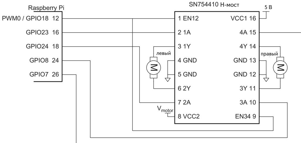
Рис. 4.35. Управление двигателем с помощью двойного H-моста
