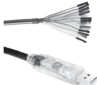
**Рис. 4.52.** Кабель USB to MPSSE компании FTDI (печатается с разрешения компании FTDI)
