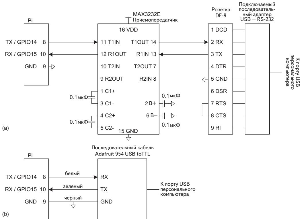
**Рис. 4.15. Последовательное подключение Pi к ПК:**
