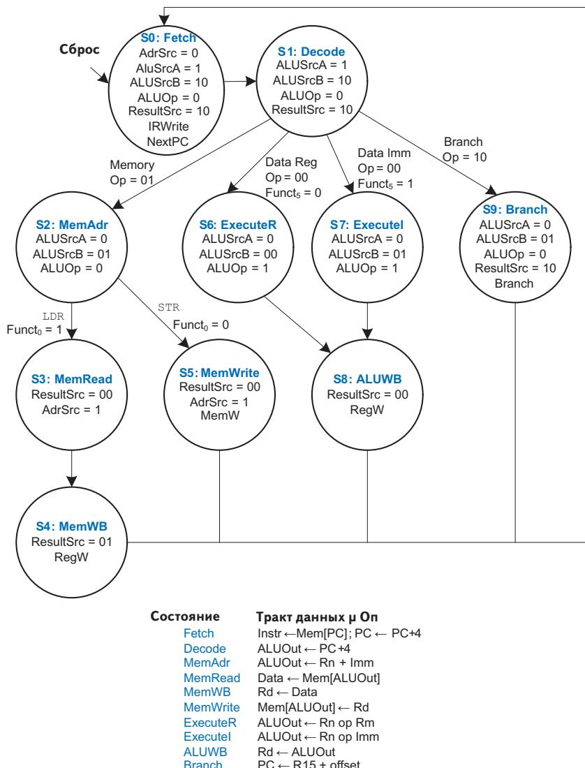
**Рис. 2.41. Полная диаграмма состояний многотактного управляемого автомата**
