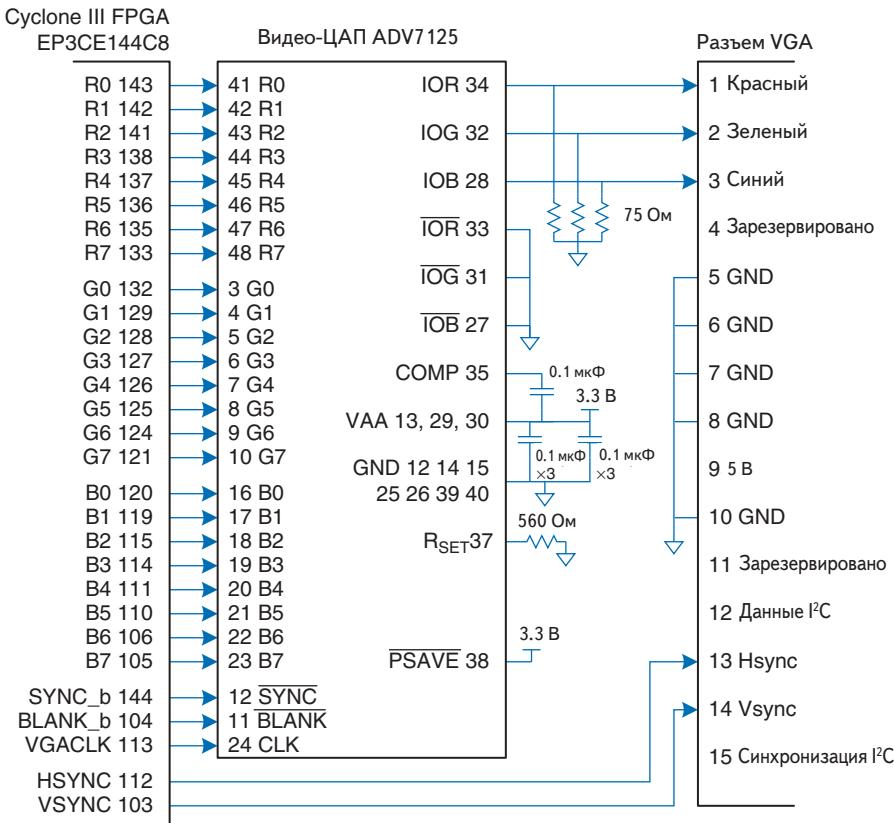
Рис. 4.28. Кабель VGA, управляемый ПЛИС через ЦАП
