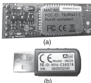
**Рис. 4.31. Модуль BlueSMiRF и USB-адаптер**
