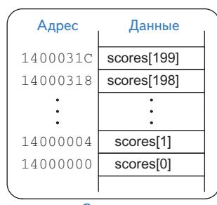
**Рис. 1.8. Область памяти, содержащая массив scores[200] и начинающаяся с базового адреса 0x14000000**
