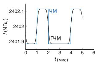
**Рис. 4.30. Формы сигналов для ЧМ и ГЧМ**
