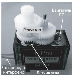
**Рис. 4.37.** Серводвигатель SG90
