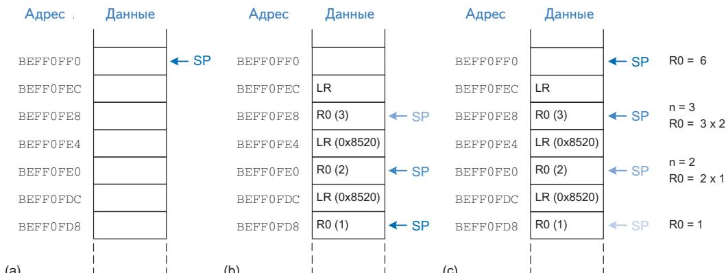
**Рис. 1.14.** Состояние стека: (a) до, (b) во время и (c) после вызова функции factorial при  $n = 3$
