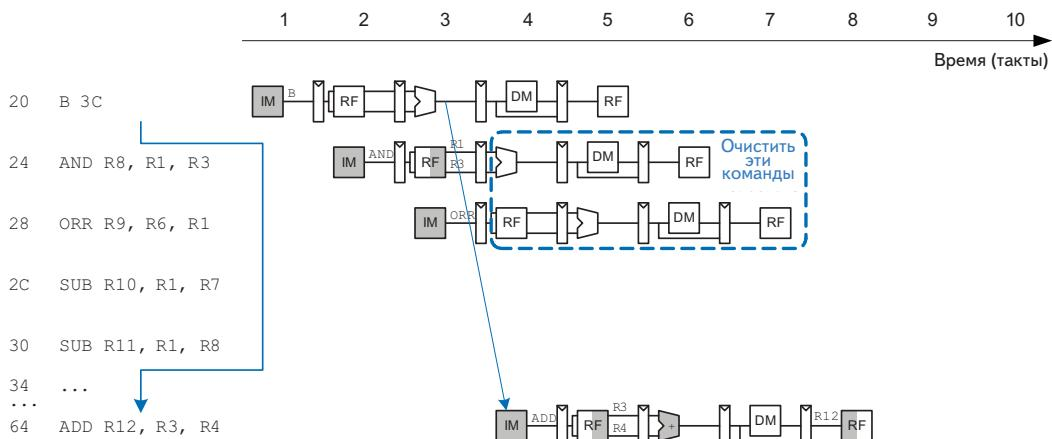
**Рис. 2.56. Абстрактная диаграмма конвейера, иллюстрирующая раннее принятие решения о переходе**
