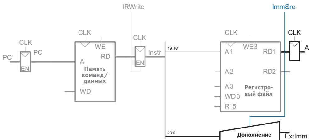
Рис. 2.21. Чтение одного операнда из регистраного файла и дополнение нулями непосредственного поля второго операнда
