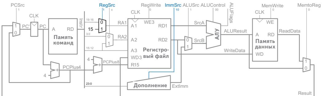
**Рис. 2.12. Расширение тракта данных для поддержки команды B**
