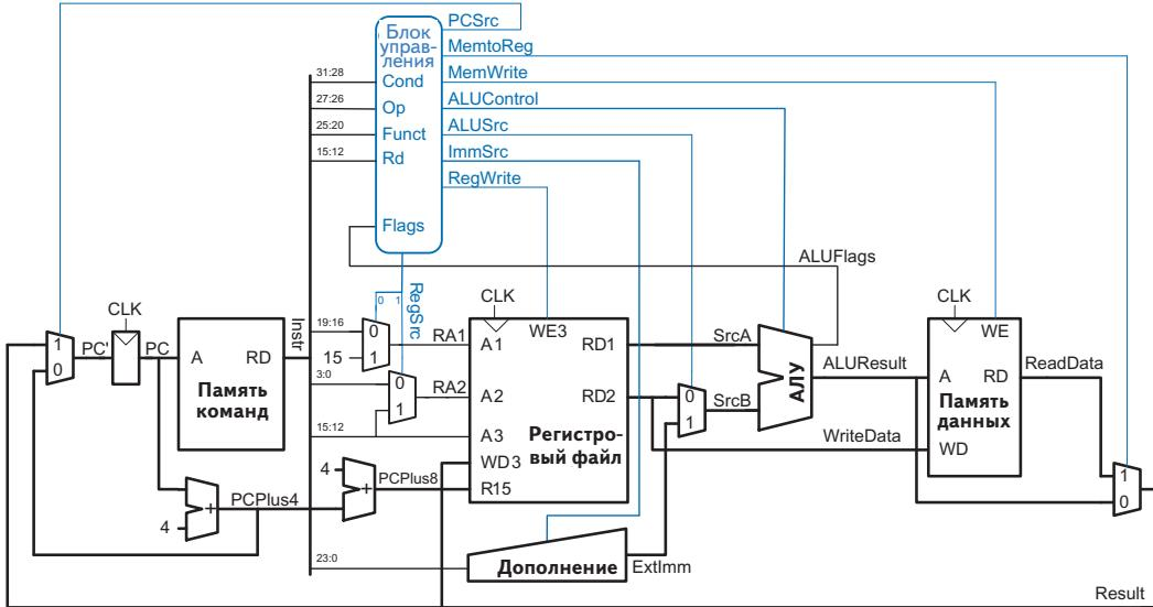
Рис. 2.13. Законченный однотактный процессор
