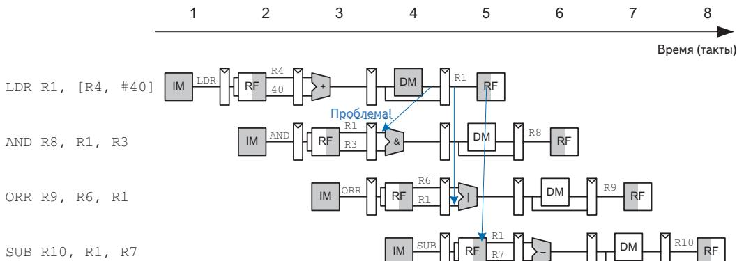
**Рис. 2.52. Абстрактная диаграмма конвейера, иллюстрирующая проблему с пробрасыванием в случае команды LDR**
