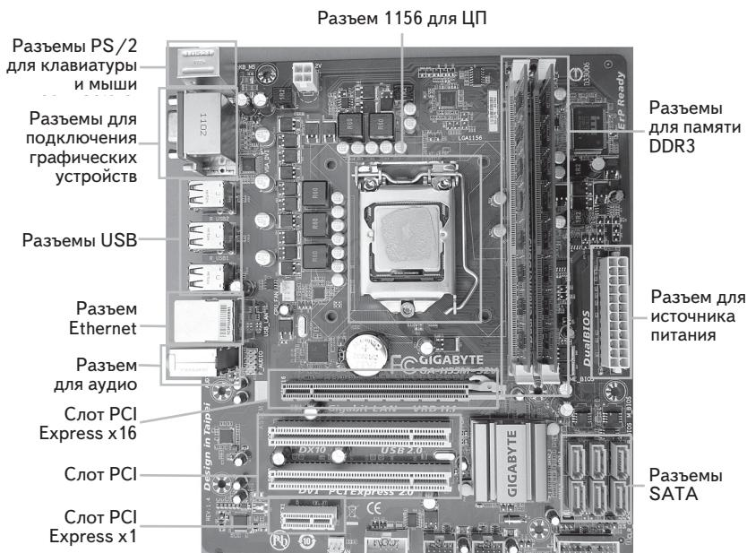
Рис. 4.48. Материнская плата Gigabyte GA-H55M-S2V
