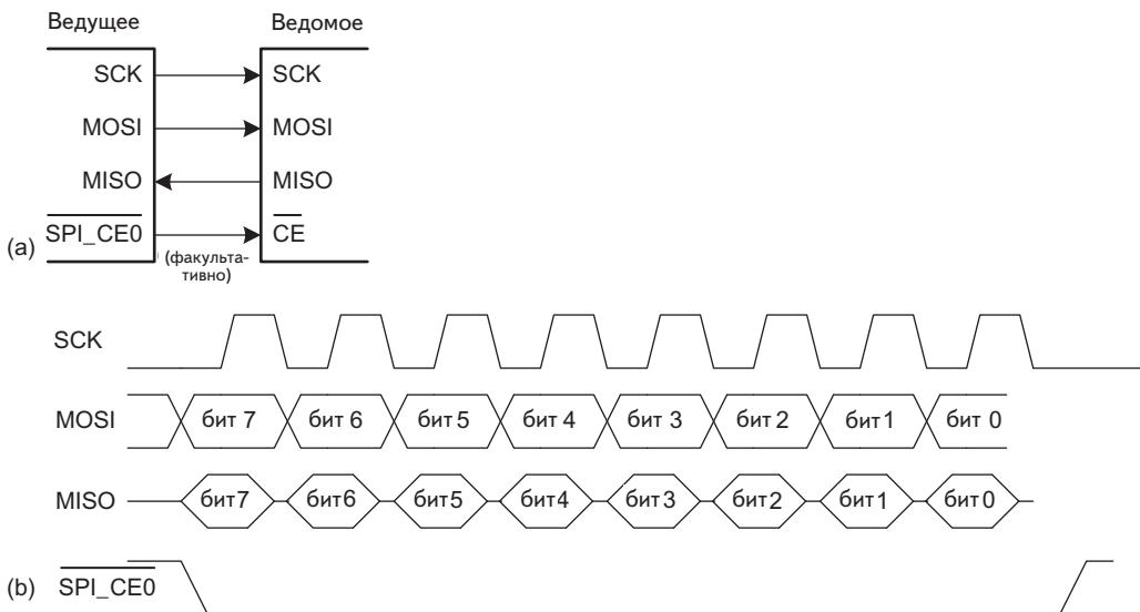
Рис. 4.6. Соединения и формы сигналов в SPI
