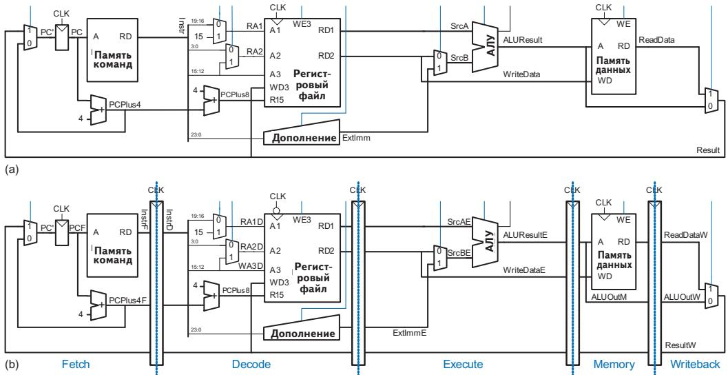
Рис. 2.44. Тракты данных: (а) однотактный и (б) конвейерный
