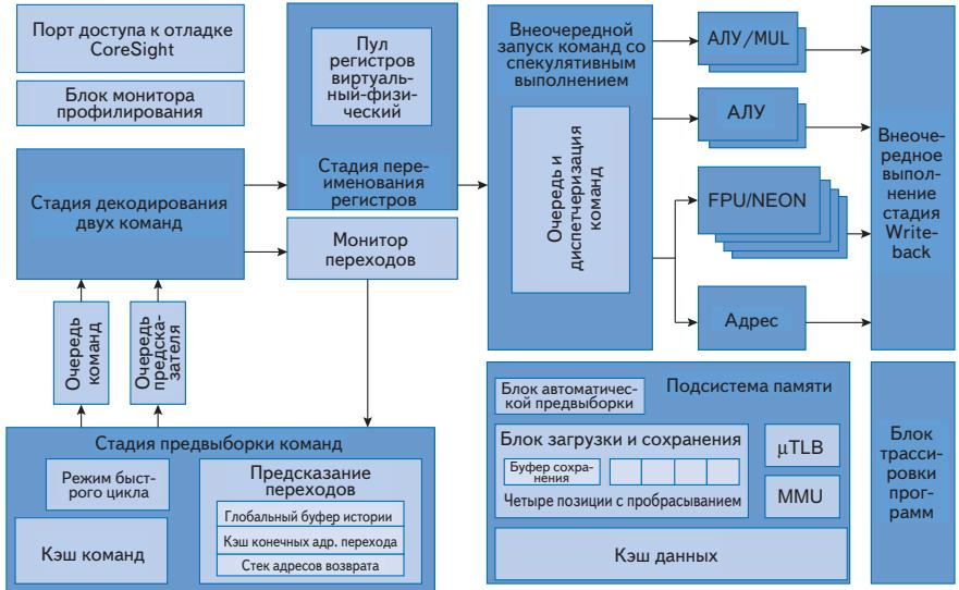
Рис. 2.71. Блок-схема процессора Cortex-A9
