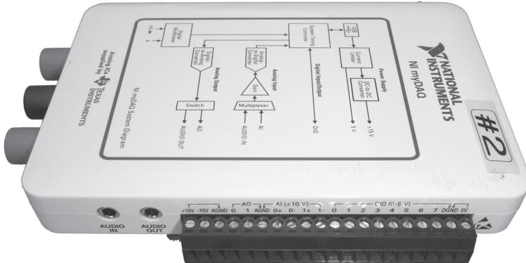
**Рис. 4.51.** Система сбора данных myDAQ фирмы National Instruments
