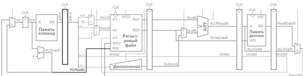
**Рис. 2.46. Оптимизированная логика работы с РС с устранением одного регистра и одного сумматора**
