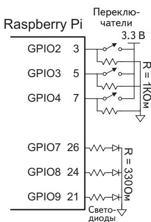
**Рис. 4.4.** Светофоры и переключатели, подключенные к контактам GPIO
