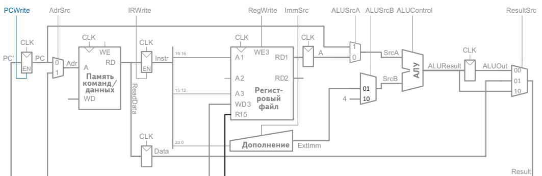
Рис. 2.26. Обработка чтения и записи в R15
