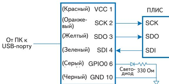
**Рис. 4.53. Подключение ПК к ПЛИС USB-кабелем C232HM-DDHSL**
