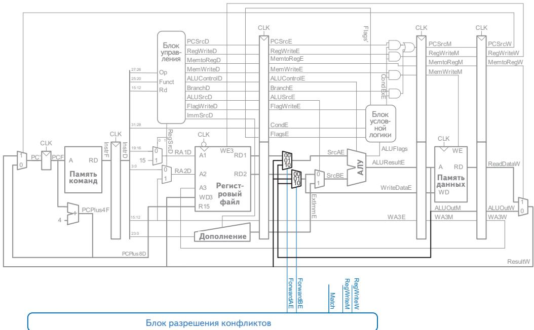
Рис. 2.51. Конвейерный процессор с прорасыванием для разрешения конфликтов
