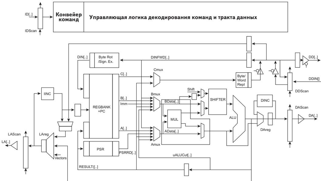
**Рис. 2.70. Блок-схема процессора ARM9**
