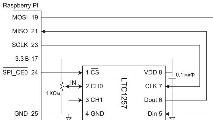
**Рис. 4.23. Преобразование аналогового входа с помощью внешнего АЦП**
