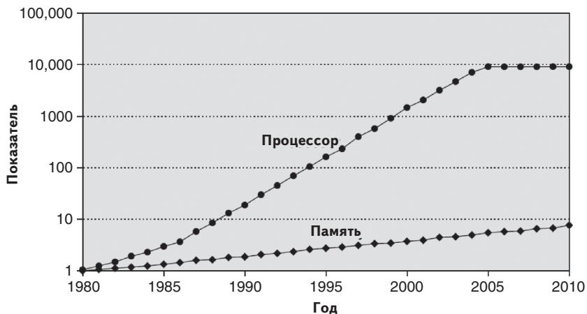
**Рис. 3.2. Разрыв в производительности процессоров и памяти**
