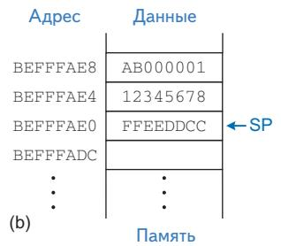
**Рис. 1.11.** Стек (а) до расширения и (б) после расширения на два слова
