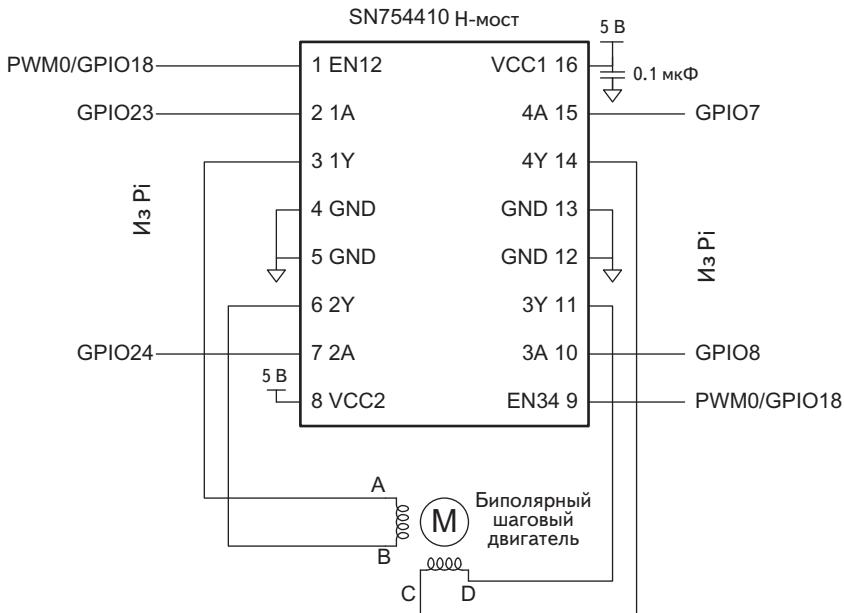
**Рис 4.44.** Биполярный шаговый двигатель в режиме прямого волнового привода с Н-мостом
