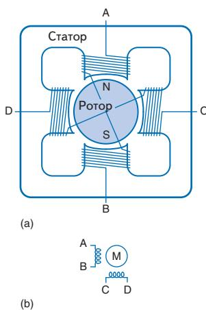
**Рис. 4.40. Двухфазный биполярный двигатель:**
