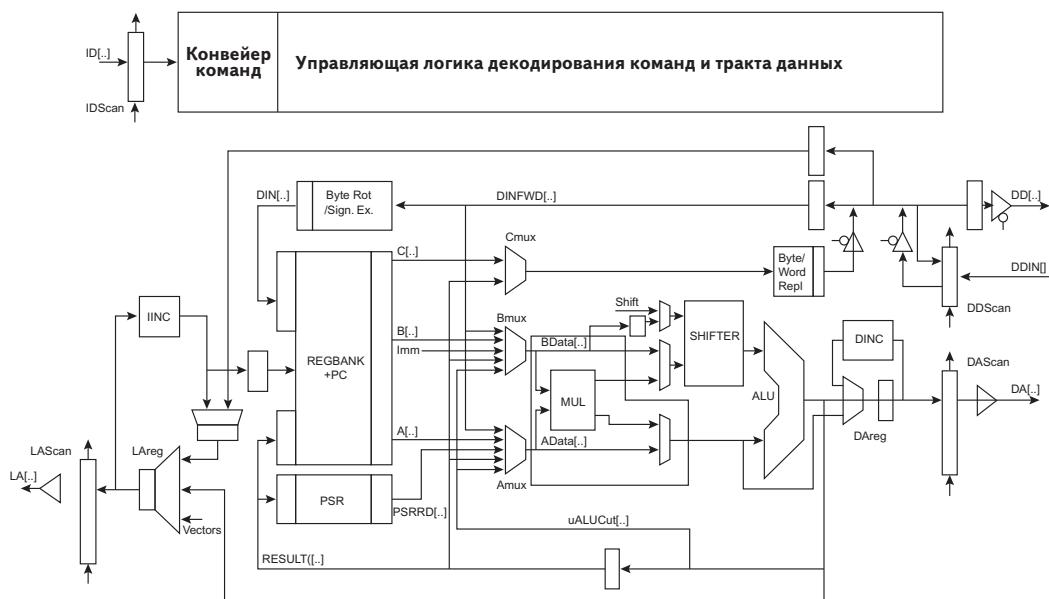
**Рис. 2.70. Блок-схема процессора ARM9**
