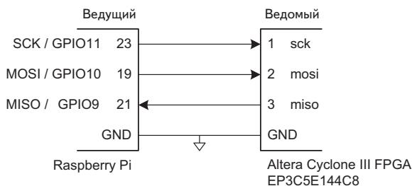
**Рис. 4.8. Соединение интерфейсов SPI в Pi и ПЛИС**
