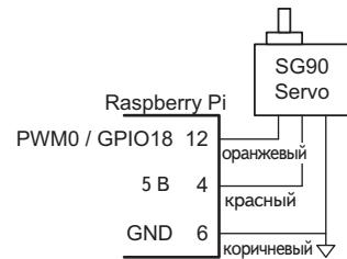
**Рис. 4.39.** Управление серводвигателем
