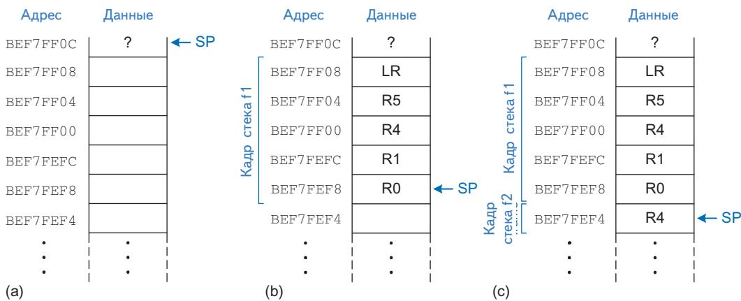
**Рис. 1.13.** Состояние стека: (а) до вызова обеих функций, (б) во время вызова  $f_1$  и (с) во время вызова  $f_2$
