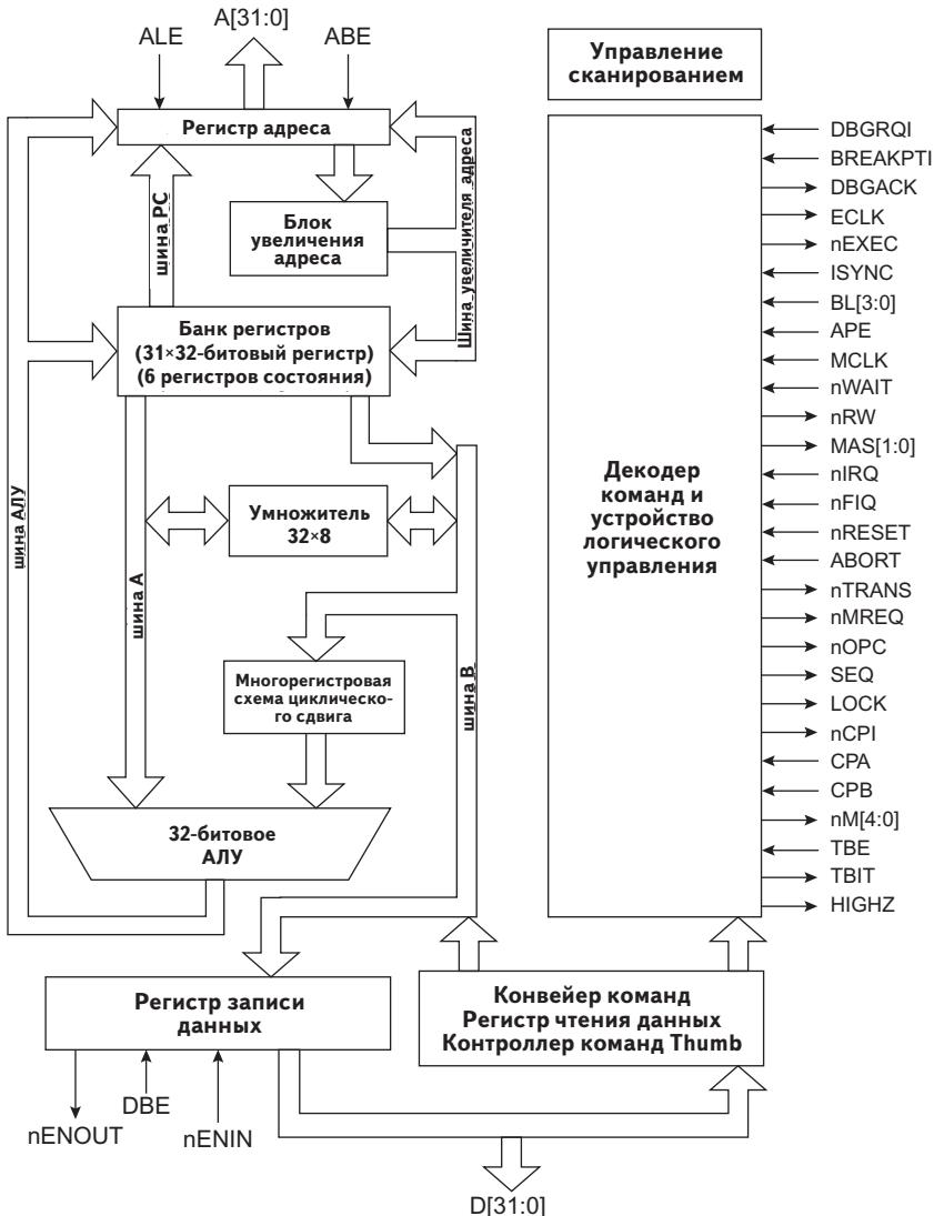
Рис. 2.69. Блок-схема процессора ARM7
