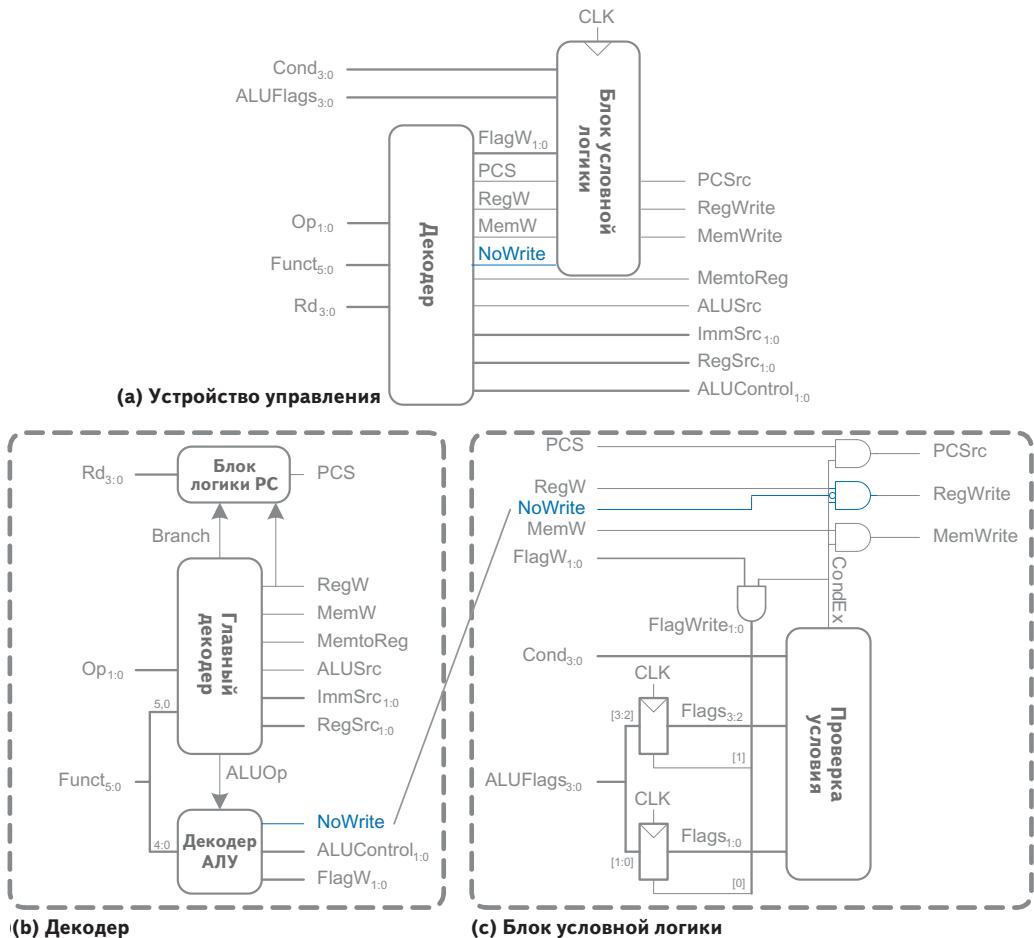
**Рис. 2.16.** Модификация устройства управления для поддержки команды CMP
