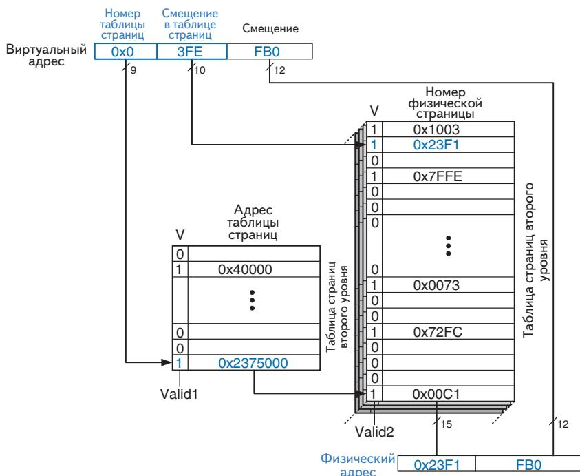
**Рис. 3.27.** Трансляция адреса с использованием двухуровневой таблицы страниц
