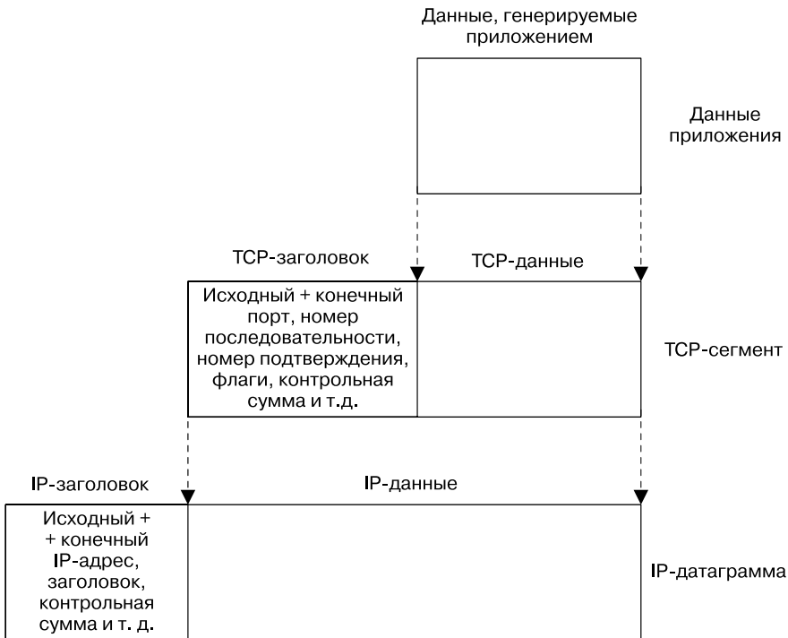
Рис. 54.4. Инкапсуляция на разных уровнях TCP/IP
