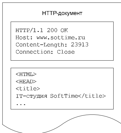
Рис. 18.7. HTTP-документ состоит из HTTP-заголовков и тела документа
