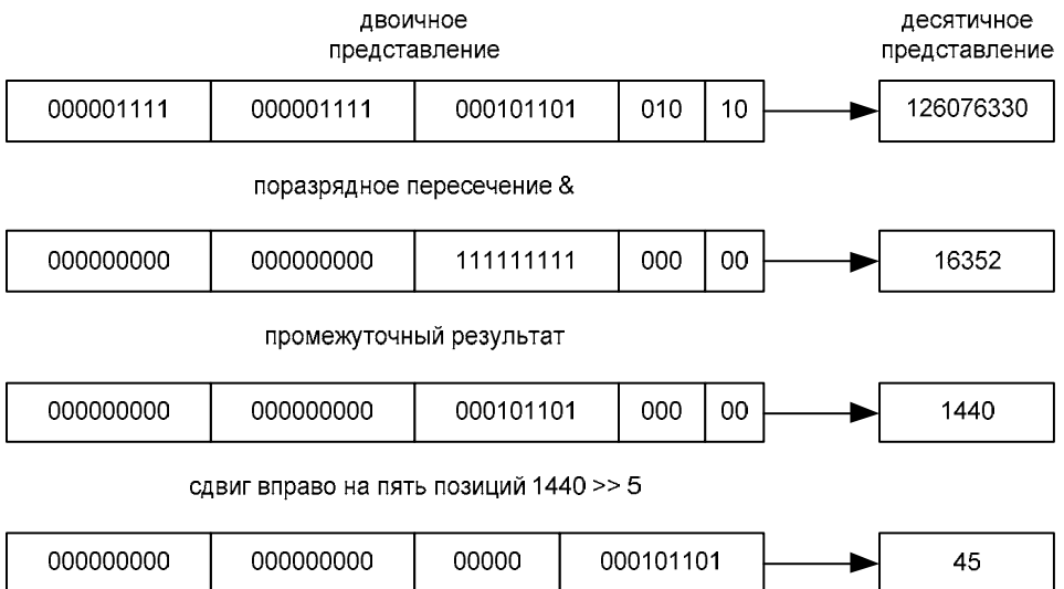
Рис. 8.10. Извлечение угла наклона графического примитива
