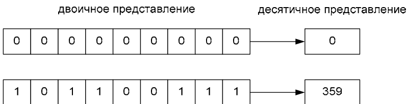
Рис. 8.6. Двоичное кодирование угла поворота
