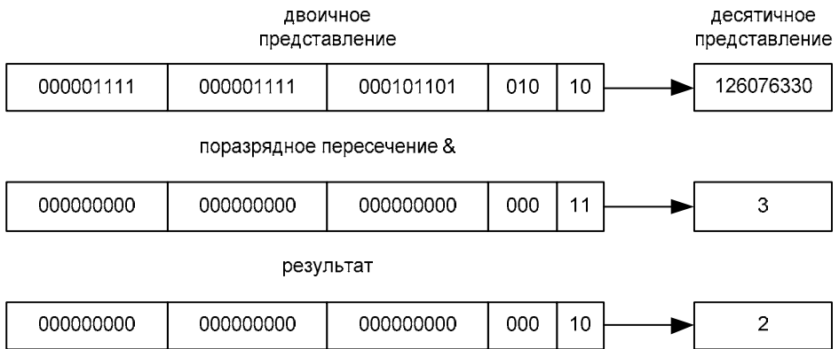
Рис. 8.9. Применение битовой маски и оператора поразрядного пересечения для извлечения формы графического примитива
