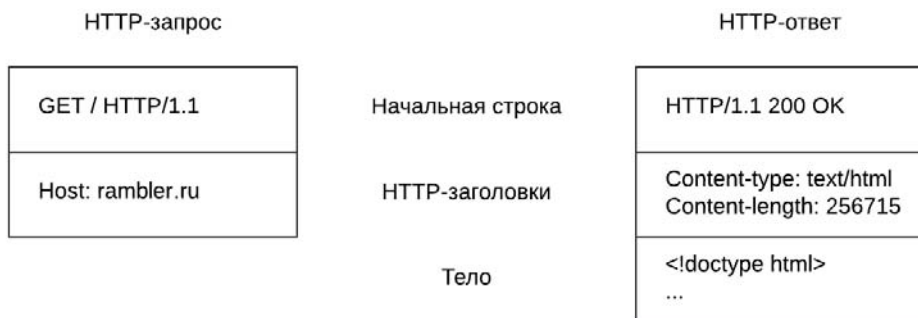
Рис. 2.5. Структура HTTP-сообщений запроса и ответа
