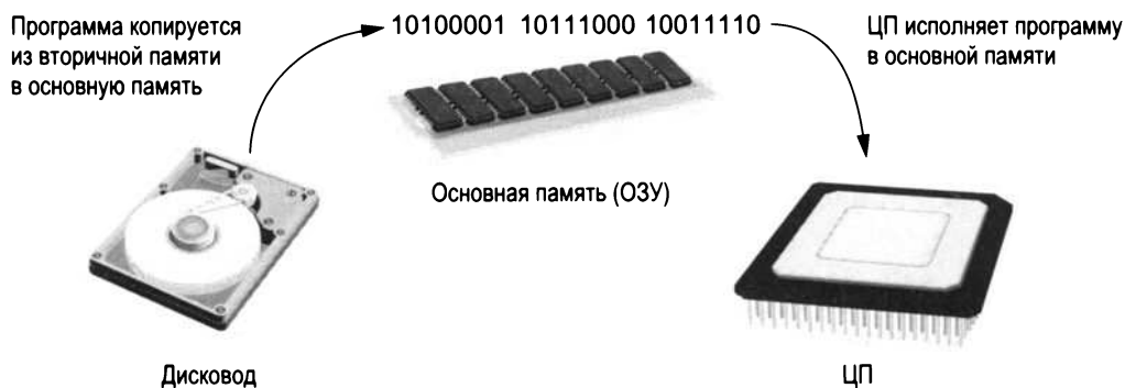
РИС. 1.15. Программа копируется в основную память и затем исполняется
