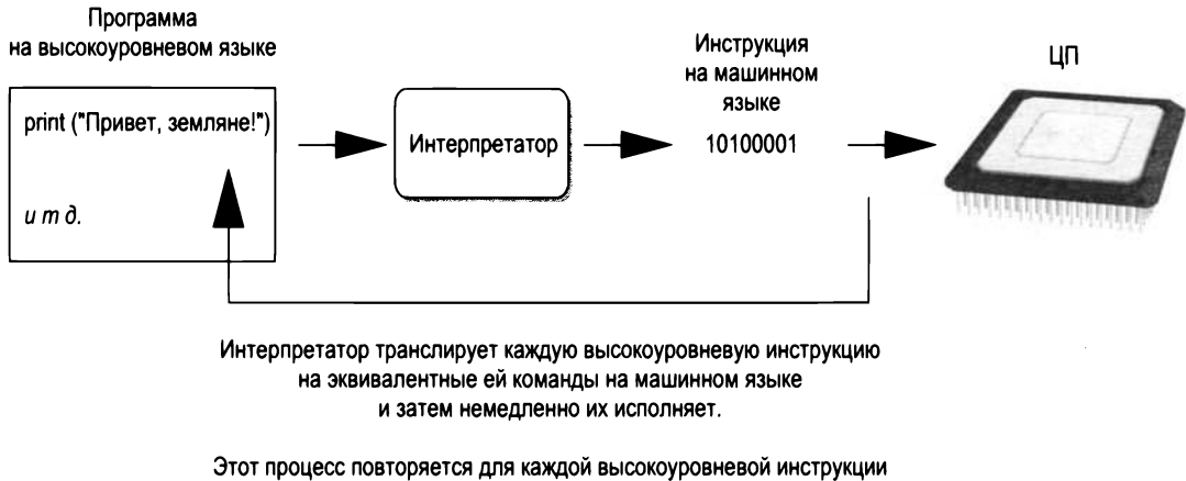
РИС. 1.19. Исполнение высокоуровневой программы интерпретатором
