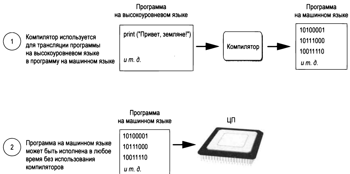
РИС. 1.18. Компилирование высокоуровневой программы и ее исполнение
