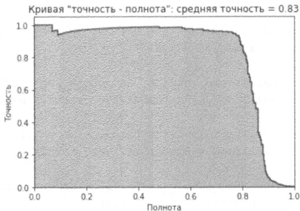
Рис. 2.8. Кривая “точность — полнота” градиентного бустинга XGBoost
