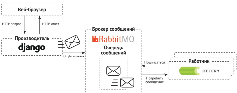
Рис. 8.17. Архитектура асинхронных заданий с участием Django, RabbitMQ и Celery
