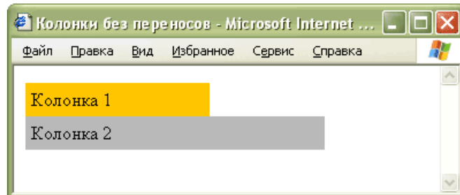
Рис. 2. Результат использования min-width в браузере Internet Explorer 6
