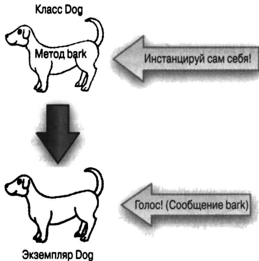
Рис. 2.2. Создание экземпляра класса
