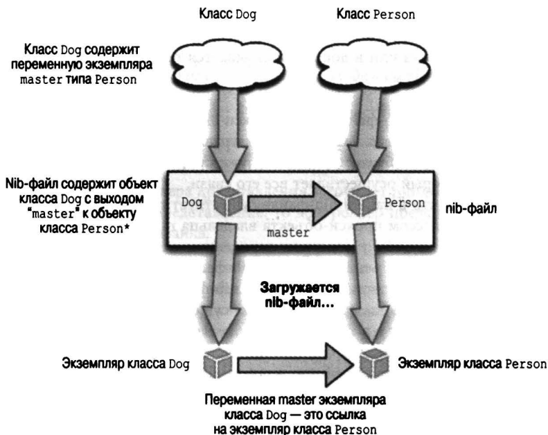
Рис. 7.7. Как выход обеспечивает ссылку на объект, созданный в nib-файле
