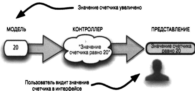
Рис. 13.2. Шаблон проектирования “модель–представление–контроллер”
