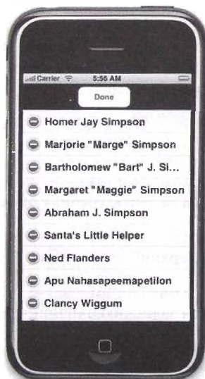
Рис. 8.7. Табличное представление после удаления строки, но все еще находящееся в режиме редактирования
