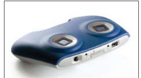
Рис. 13. PS25503 Impulse — демонстрационный набор с ПО для передачи ЭКГ по каналу Bluetooth на устройства с ОС Android
