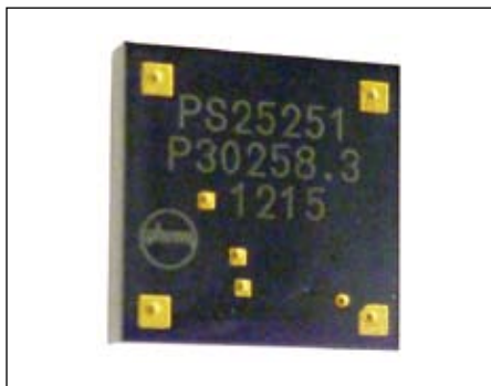
Рис. 7. Датчики PS25251, PS25253 и PS25255 в корпусе QFN для контактных измерений (сухой контакт)
