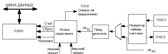
Рисунок 35. Функциональная схема счетчика
