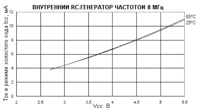
Рисунок 170. Зависимость потребляемого тока в режиме холостого хода (Idle) от напряжения питания (тактирование внутренним RC-генератором частотой 8МГц)
