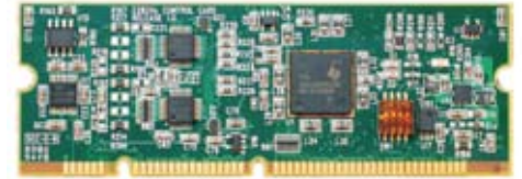
Рис. 3. Delfino C28343 controlCARD
