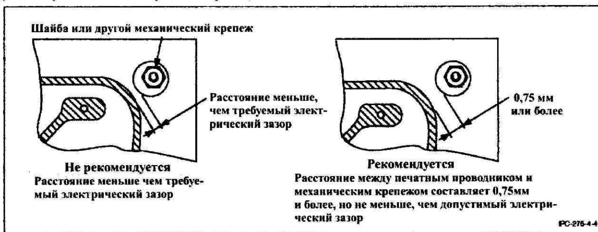
Рис. 8-4 Зазоры незащищенной платы
