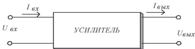
Рис. 2.12. Представление усилителя четырехполюсником
