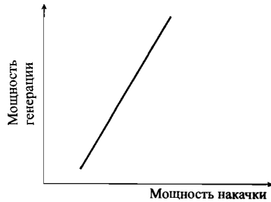
Рис. 6.18. Зависимость мощности генерации волоконного лазера от мощности накачки
