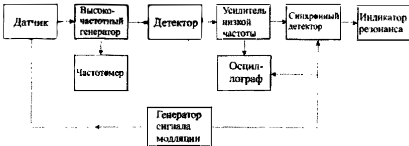
Рис. 14.2. Структурная схема ЯМР-магнитометра с неподвижным образцом
