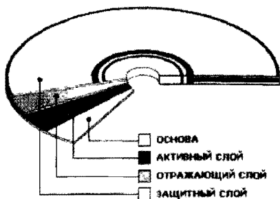
Рис. 25.13. Структура CD-R диска
