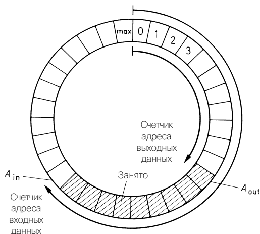
Рис. 10.16. FIFO в виде кольцевого ЗУ
