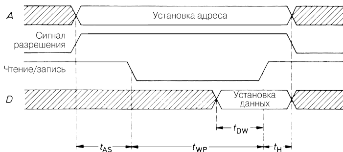
Рис. 10.5. Временная диаграмма процесса записи. t_{AS} – время установки адреса; t_{WP} – длительность импульса записи; t_{DW} – время готовности данных к записи; t_H – время занятости
