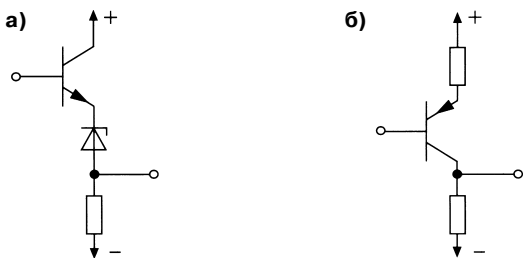
Рис. 5.9. Способы смещения потенциала: а – стабилитрон; б – комплементарный транзистор
