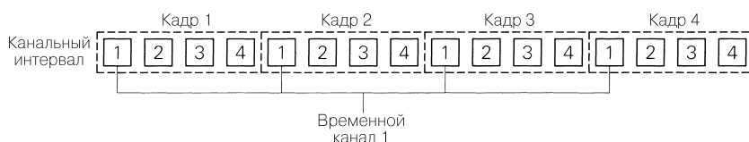
Рис. 24.76. Кадры и временные каналы при временном уплотнении
