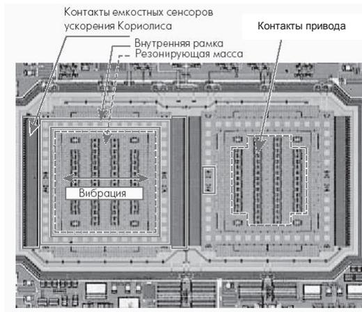
Рис. 10.49. Гироскоп семейства ADXRS.
