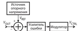
Рис. 6.3. Блок-схема устройства управления.
