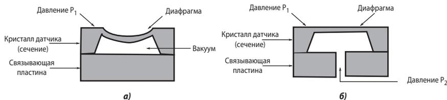
**Рис. 10.59.** Датчики абсолютного (а) и относительного (б) давления.
