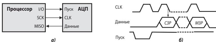
**Рис. 9.48.** Простейший последовательный интерфейс.
