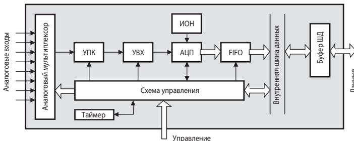
Рис. 9.59. Блок-схема системы сбора данных.
