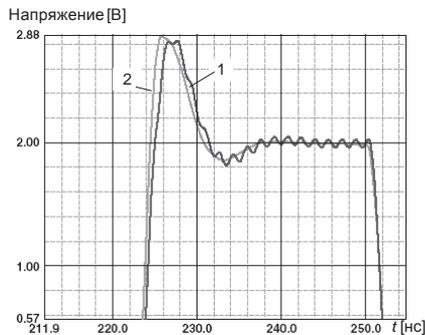
**Рис. 3.22.** Отклик на входной импульс без слоя (1) и со слоем земли (2).
