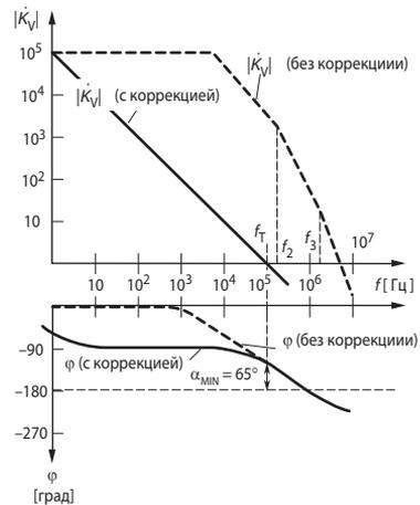
Рис. 1.18. Логарифмические частотные характеристики ОУ с полной частотной коррекцией и без неё.
