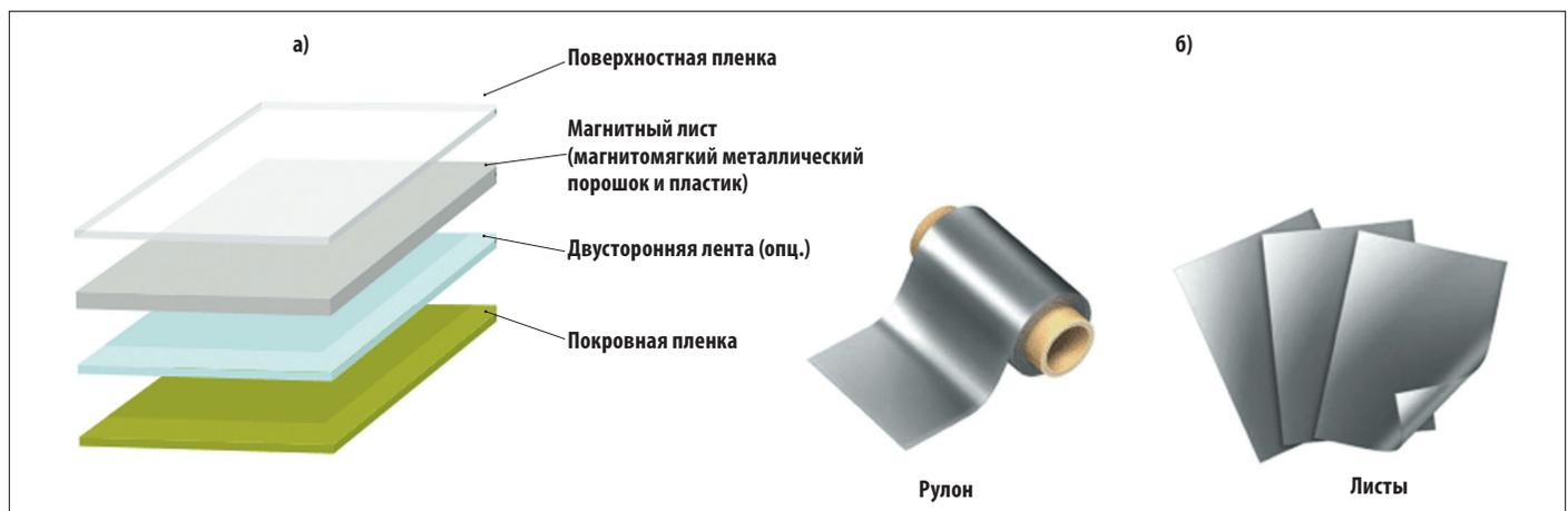
Рис. 2. а) Строение листа Flexield; б) виды его изготовления
