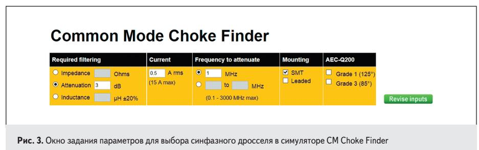
Рис. 3. Окно задания параметров для выбора синфазного дросселя в симуляторе CM Choke Finder
