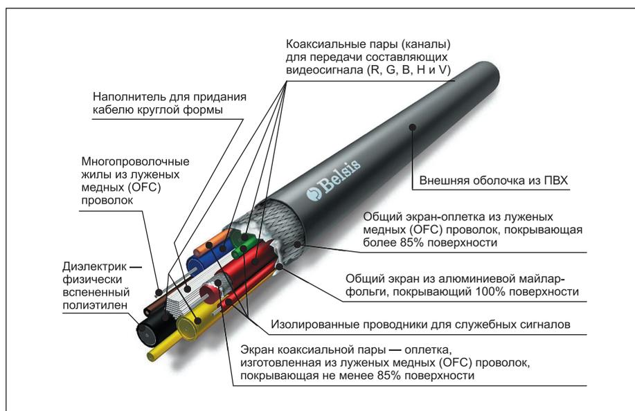
Рис. 3. Конструктивные особенности кабеля HDMI-интерфейса
