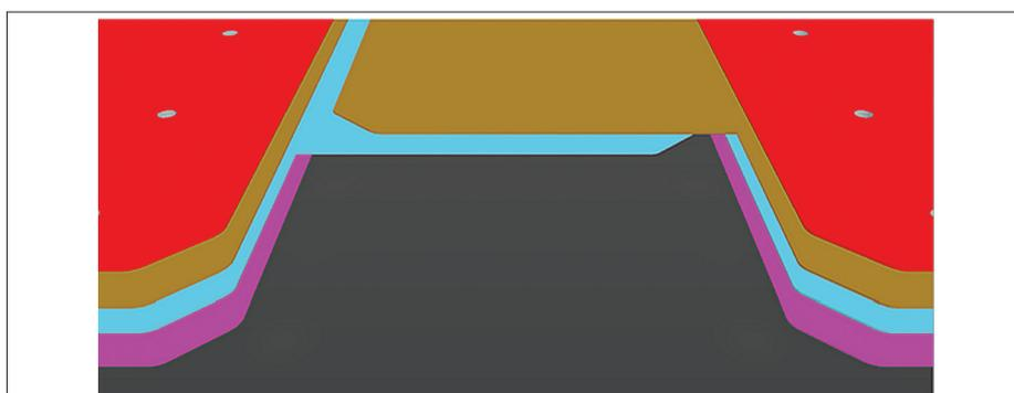
Рис. 14. Края треугольной формы позволяют улучшить работу платы при высоких напряжениях
