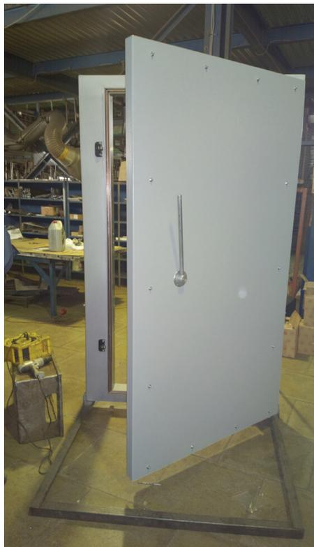
Рис. 4. Дверь для экранированных и безэховых камер. Опытный образец
