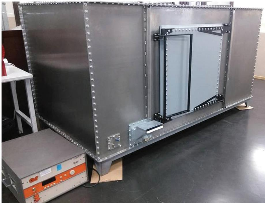
Рис. 8. Опытный образец реверберационной камеры, построенной в ИЛ АО «ТЕСТПРИБОР»
