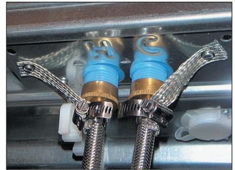
Рис. 1. Подключение экранирующей оплетки силового кабеля
