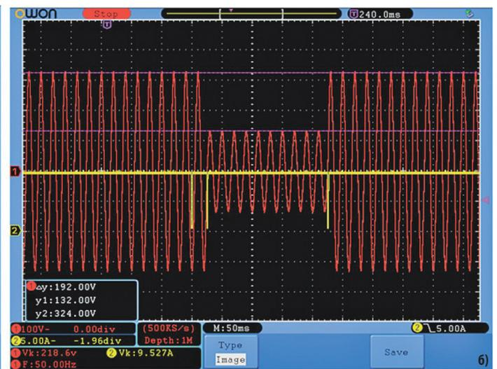
Рис. 8. а) Обнуление напряжения на один цикл; б) провал напряжения до 40% уровня от исходной величины в течение 10 циклов
