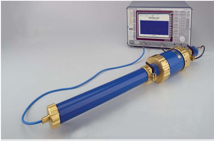
**Рис. 4.** Установка для измерения эффективности экранирования с помощью триаксиальной линии
