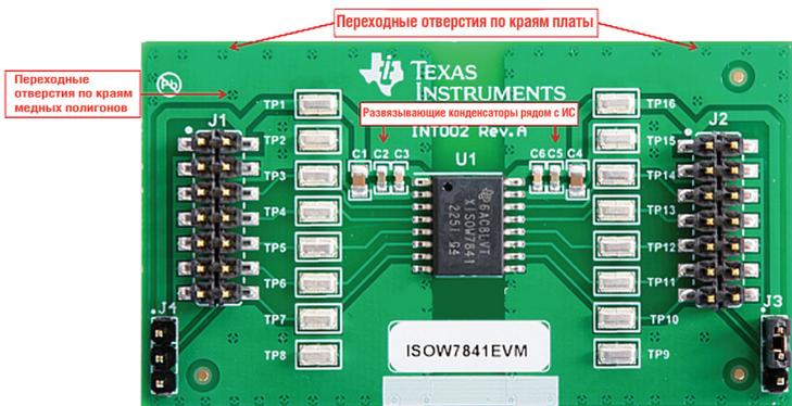
Рис. 7. Оценочный модуль для изолятора ISOW7841
