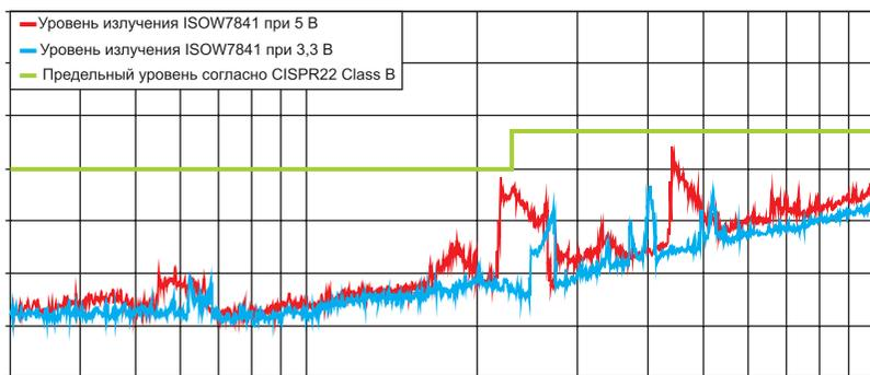
Рис. 5. Уровень излучения устройства ISOW7841 при входном напряжении величиной 5 и 3,3 В
