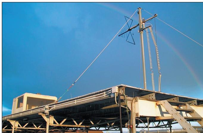
Рис. 4. Лаборатория OATS компании Agilent Technologies для исследований аппаратуры на ЭМС
