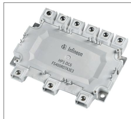
Рис. 1. IGBT-модуль HybridPACK1-DC6 рассчитан на напряжение 705 В и номинальный ток 400 А. Благодаря шести клеммам шины постоянного тока эта конструкция имеет очень низкую паразитную индуктивность
