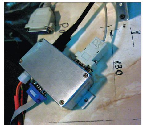
Рис. 7. Переработанный узел изолированного интерфейса с кабелем (ленточный кабель с синим разъемом), помеха от которого ранее привела к отказу изделия на сертификационных испытаниях. Изображение предоставлено компанией «Модуль-98»
