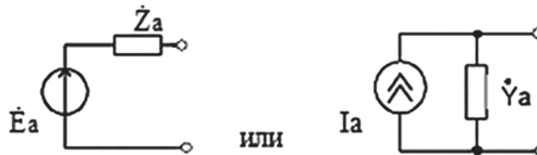
Рис. 2.5. Представление приемной антенны в виде генератора ЭДС или генератора тока
