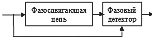
Рис. 9.7. Принцип построения частотного детектора с использованием фазосдвигающей цепи
