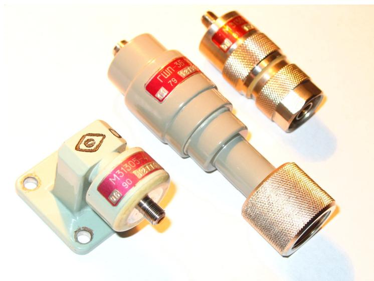
**Рисунок 3.1 – Генераторы шума на ЛПД в волноводном и коаксиальном исполнении**
