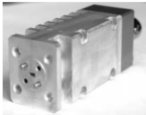
Рис.14.2. Внешний вид генератора на ЛПД диапазона 90 – 100 ГГц (производства НПО «Орион»[18])
