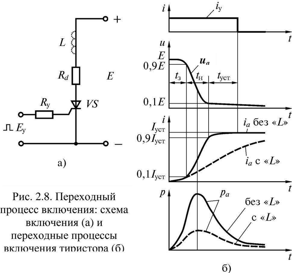
Рис. 2.8. Переходный процесс включения: схема включения (а) и переходные процессы включения тиристора (б)
