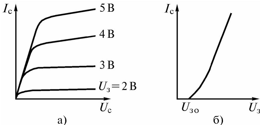
Рис. 2.19. Выходные (а) и передаточные (б) характеристики ПТИЗ с индуцированным каналом для схемы с ОИ
