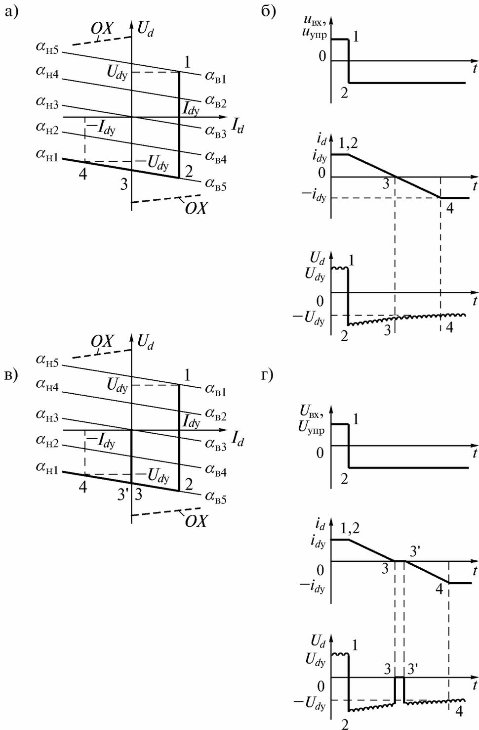
Рис. 9.18. Переходные процессы при реверсе тока в активно-индуктивной нагрузке при совместном (а, б) и раздельном (в, г) управлении.
