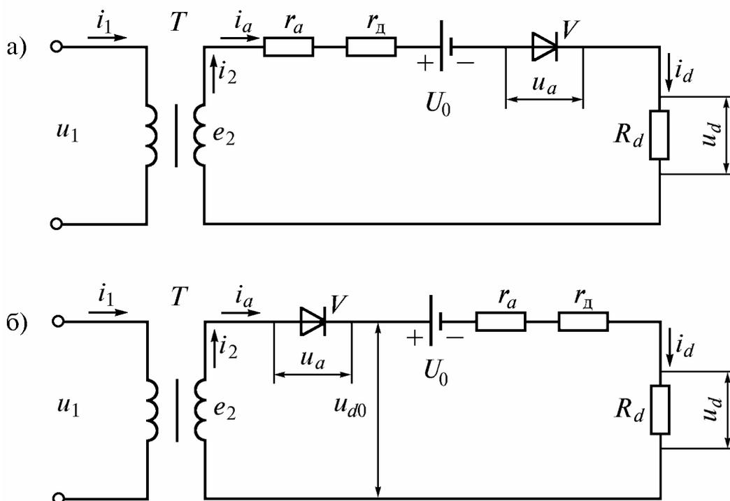
Рис. 4.4. Схема замещения однофазного однополупериодного выпрямителя с учетом неидеальности вентиля и трансформатора (а) и ее преобразование (б)
