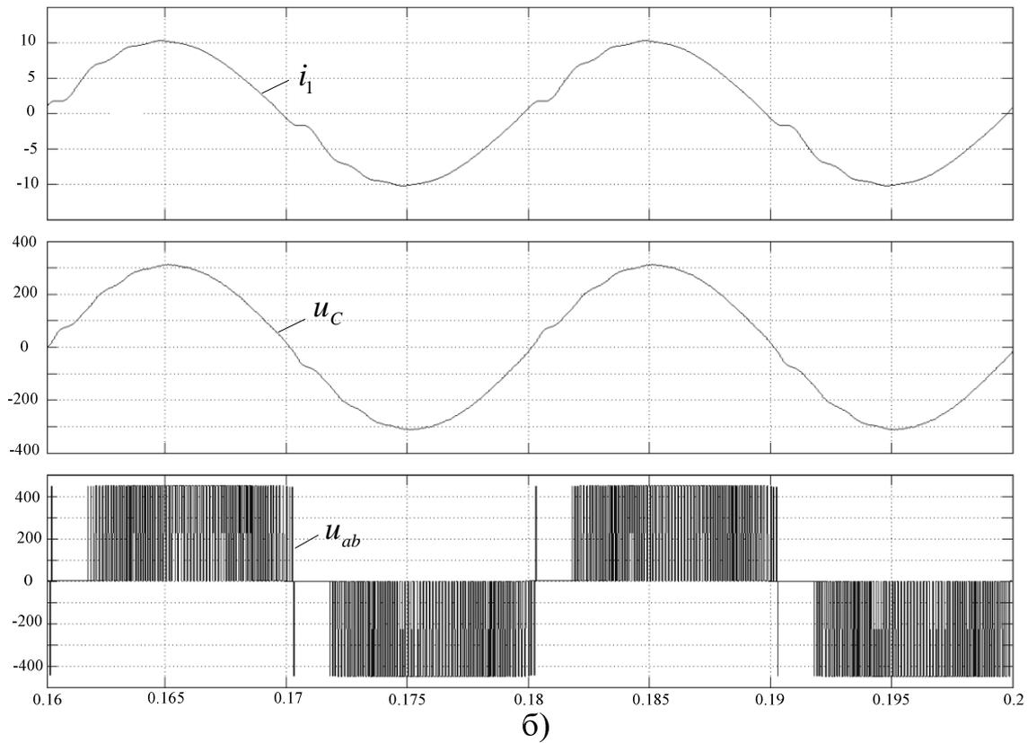
Рис. 15.4. Осциллограммы тока  $i_1$ , потребляемого из сети ОПН с несимметричным управлением, напряжения сети  $u_C$  и напряжения на диагонали моста ОПН  $u_{ab}$  без фильтра (а) и с фильтром (б)
