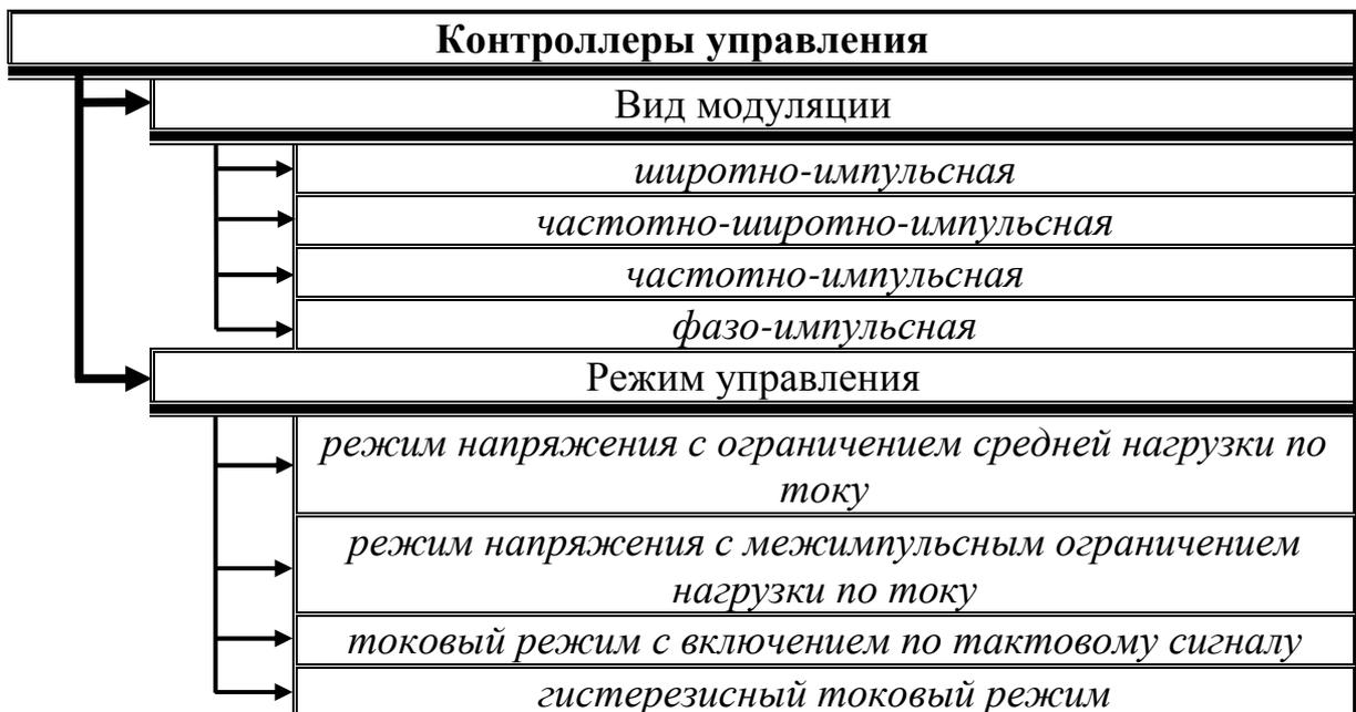
Рис. 19.1. Классификация контроллеров управления
