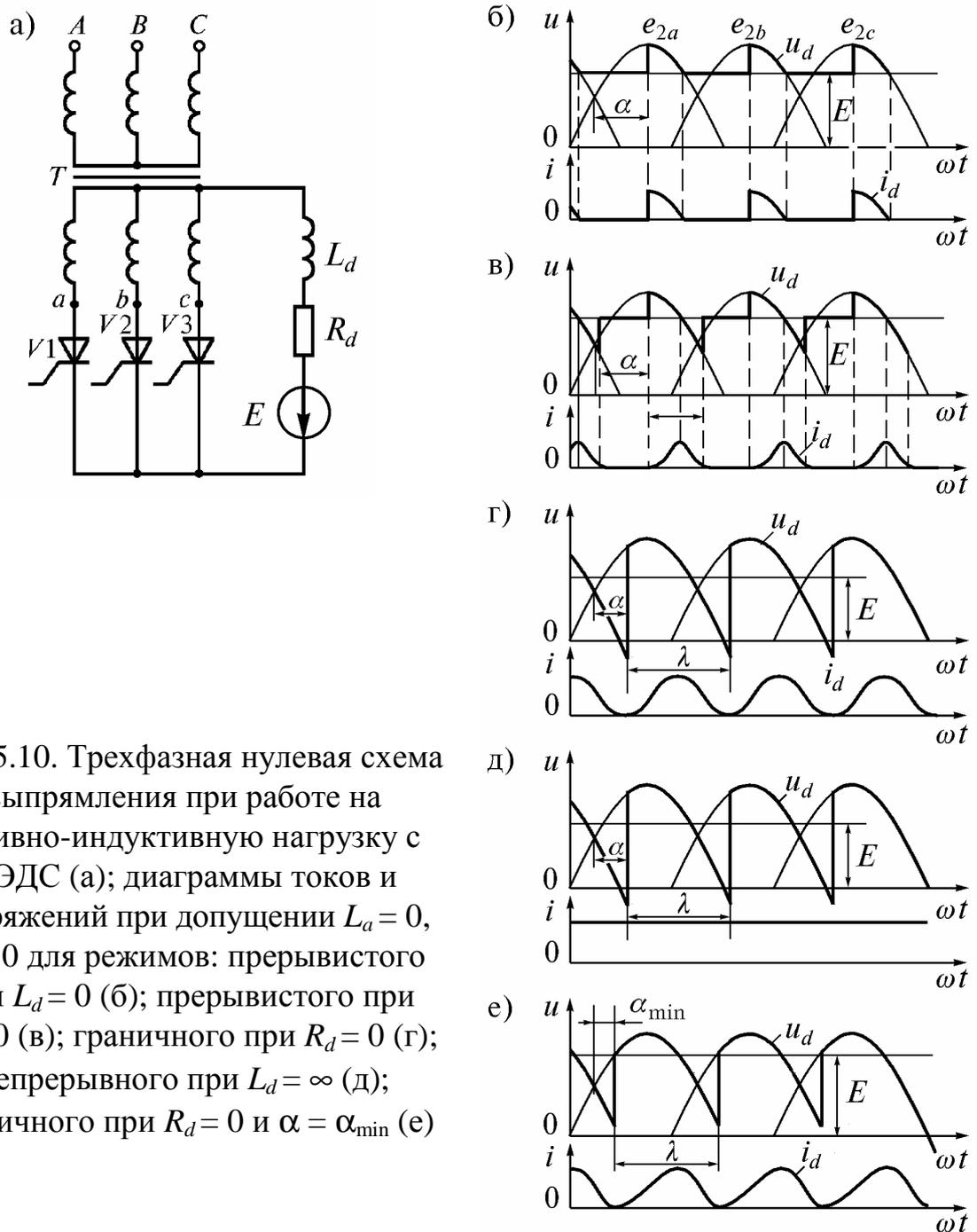
Рис. 5.10. Трехфазная нулевая схема выпрямления при работе на активно-индуктивную нагрузку с ПЭДС (а); диаграммы токов и напряжений при допущении  $L_a = 0$ ,  $R_a = 0$  для режимов: прерывистого при  $L_d = 0$  (б); прерывистого при  $R_d = 0$  (в); граничного при  $R_d = 0$  (г); непрерывного при  $L_d = \infty$  (д); граничного при  $R_d = 0$  и  $\alpha = \alpha_{\min}$  (е)
