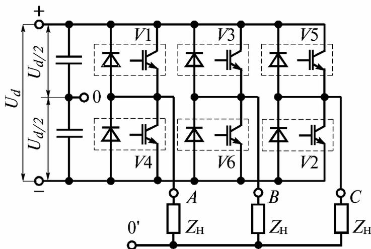
Рис. 11.16. Трехфазный АИН с симметричным источником питания
