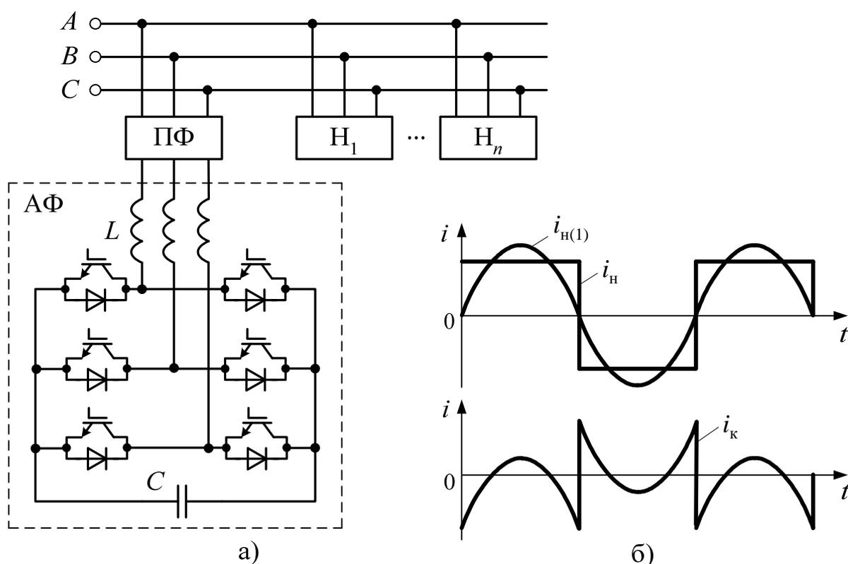
Рис. 18.4. Схема подключения активного фильтра АФ к сети параллельно нагрузкам  $N_1 \dots N_n$ , искажающим ток, потребляемый из сети (а), и пояснения к определению требуемого тока активного фильтра  $i_k$  (б)
