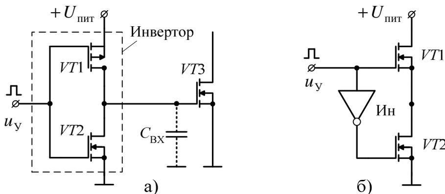
Рис. 19.22. Управление ПТИЗ с помощью логического КМОП–инвертора (а) и комплементарная пара на основе МОП–транзисторов с одинаковой проводимостью (б)
