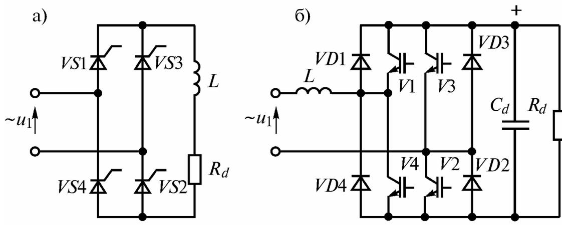
Рис.12.1. Управляемые выпрямители тока (а) и напряжения (б)
