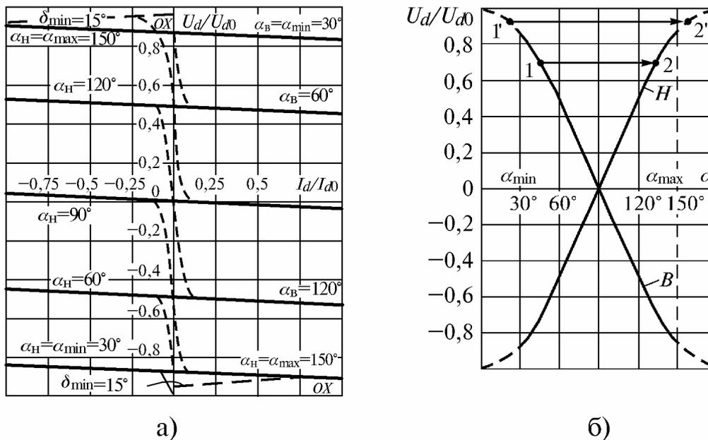
Рис. 8.2. Внешние, ограничительные (а) и регулировочные (б) характеристики реверсивного преобразователя. Участки внешних характеристик в прерывистом режиме при раздельном управлении даны пунктиром
