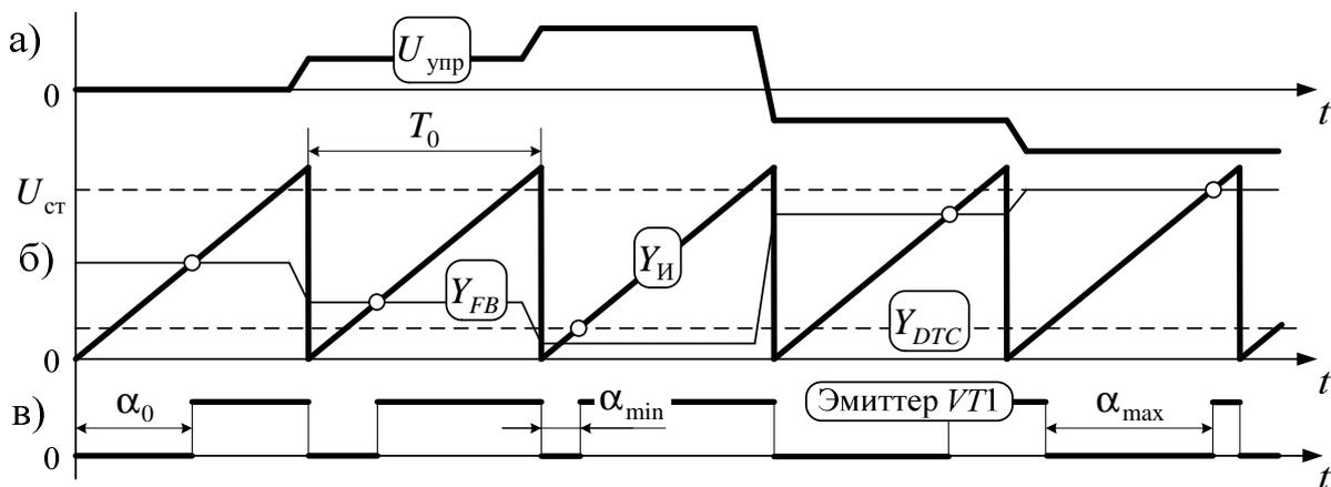
Рис. 19.14. Временные диаграммы сигналов ФСУ с возможностью установки начального  $\alpha_0$  и ограничения минимального  $\alpha_{\min}$  и максимального  $\alpha_{\max}$  углов управления на основе ШИМ-контроллера TL494
