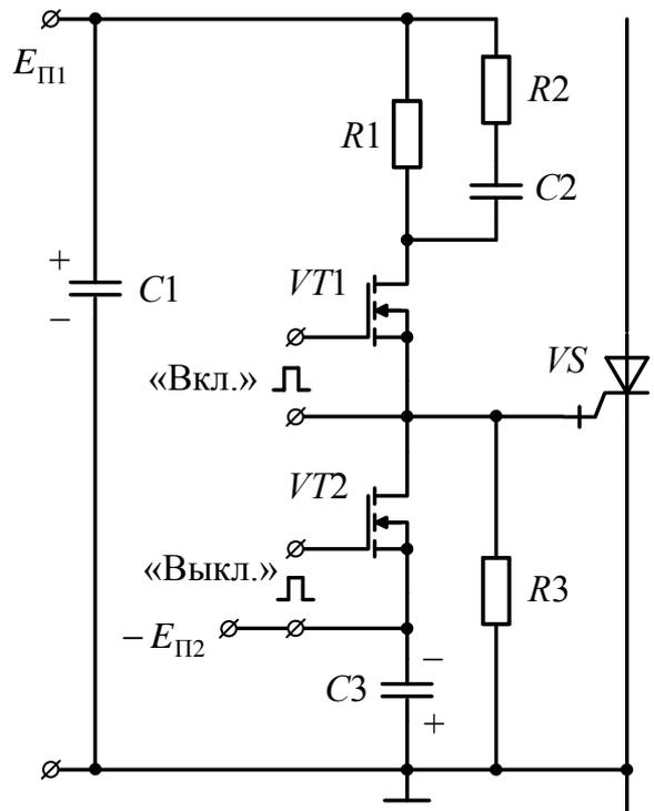
Рис. 19.19. Усилитель мощности импульсов управления запираемого тиристора
