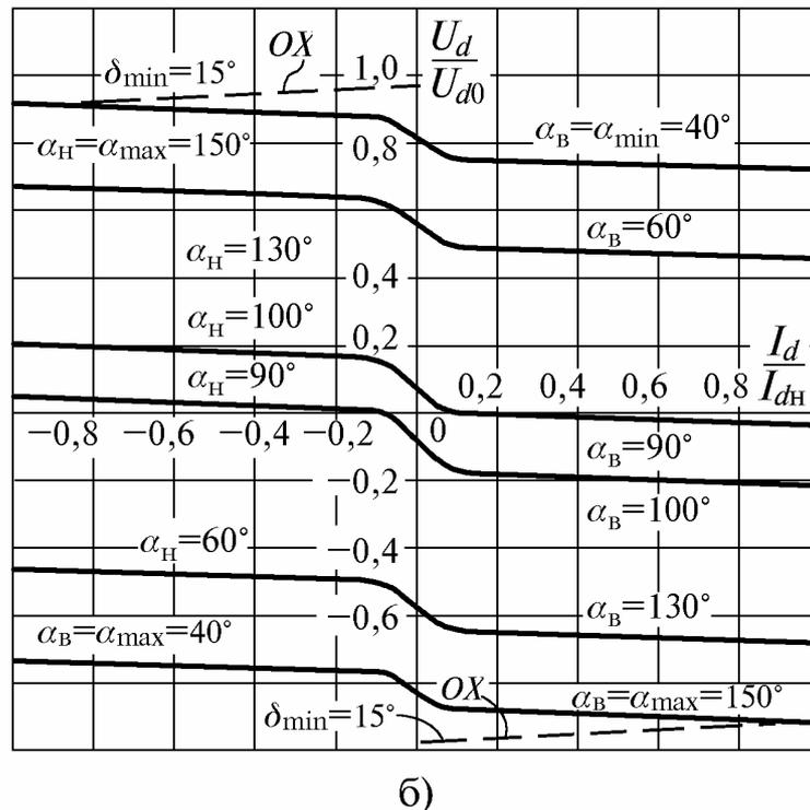
Рис. 8.4. Внешние и ограничительные характеристики реверсивного преобразователя с совместным управлением: а) при линейном согласовании ( $\alpha_B + \alpha_H = 180^\circ$ ), б) при нелинейном согласовании ( $\alpha_B + \alpha_H = 190^\circ$ )
