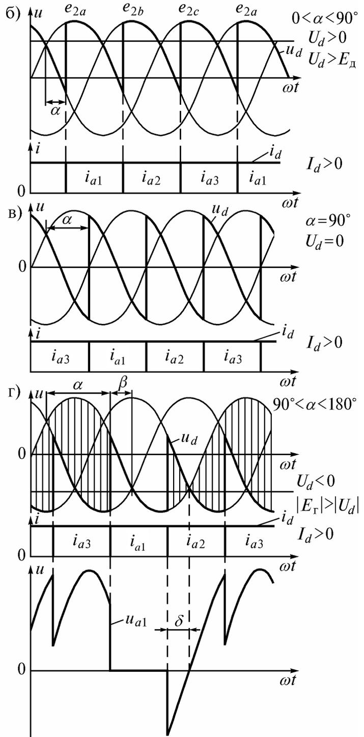
Рис. 7.2. Переход из выпрямительного в инверторный режим в трехфазной нулевой схеме (а); б, в, г – диаграммы токов и напряжений при различных углах  $\alpha$ , иллюстрирующие процессы в схеме
