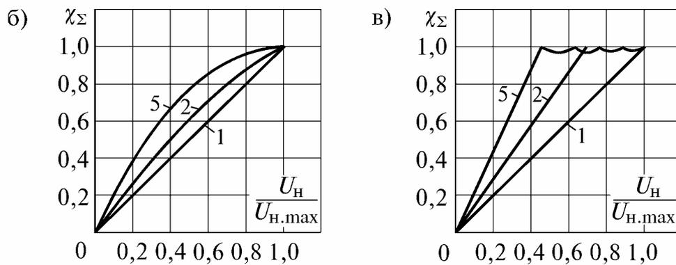
Рис. 14.3. Диаграммы токов при синхронизации трех ППН (а) и результирующий коэффициент мощности группы при независимой работе (б) и синхронизированном управлении (в)
