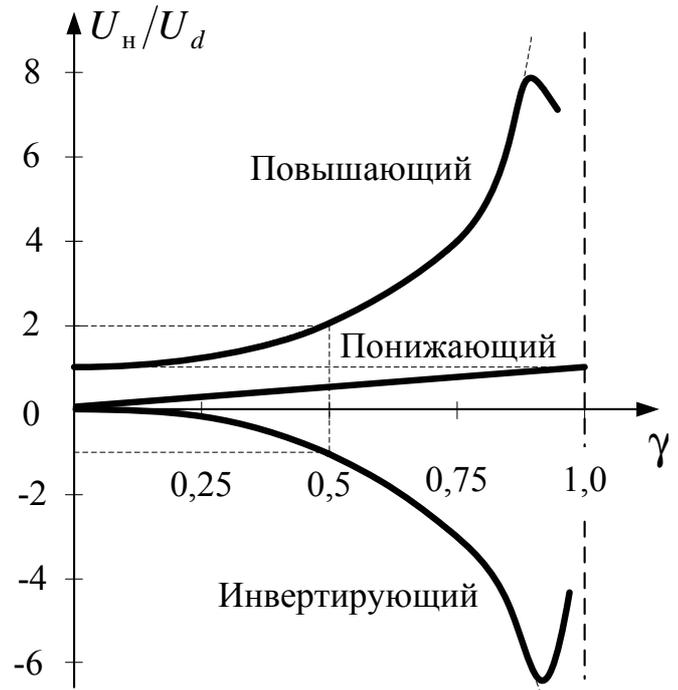
Рис. 10.2. Регулировочные характеристики понижающего, повышающего и инвертирующего ППН
