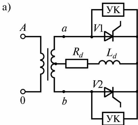
Рис. 6.9. Однофазная нулевая схема с искусственной коммутацией (а) и диаграммы напряжений и токов в схеме при  $\alpha = 30^\circ$  (б) и  $\alpha = -30^\circ$  (в) (диаграммы приведены для случая  $L_d = \infty, L_a = 0$ )
