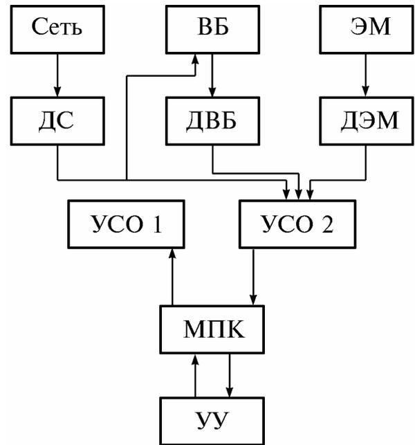
Рис. 9.21. Функциональная схема системы микропроцессорного управления вентиляльным электроприводом постоянного тока
