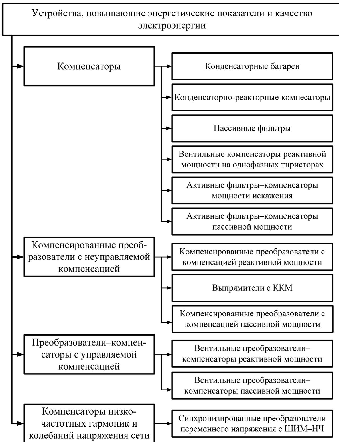
Рис. 18.1. Классификация устройств, повышающих энергетические показатели и качество электроэнергии
