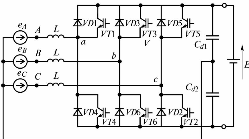
Рис. 12.7. Трехфазная мостовая схема управляемого выпрямителя напряжения
