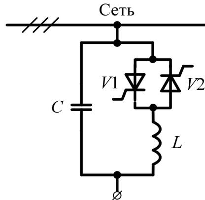
Рис. 18.3. Схема конденсаторно-реакторного компенсатора
