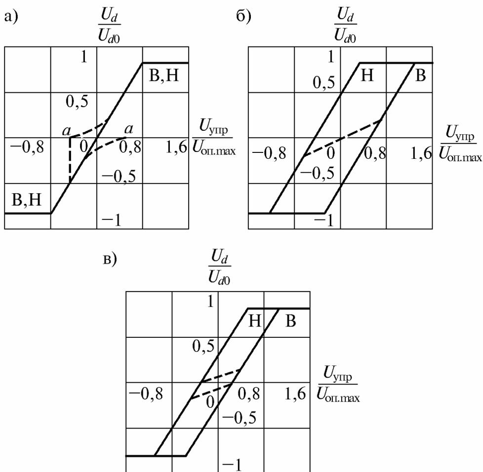
Рис. 9.17. Регулировочные характеристики двухкомплектного реверсивного преобразователя (вместе с системой управления) при различных начальных углах согласования: а)  $\alpha_0 = 90$  эл.град; б)  $\alpha_0 = 120$  эл.град; в)  $\alpha_0 = 105$  эл.град
