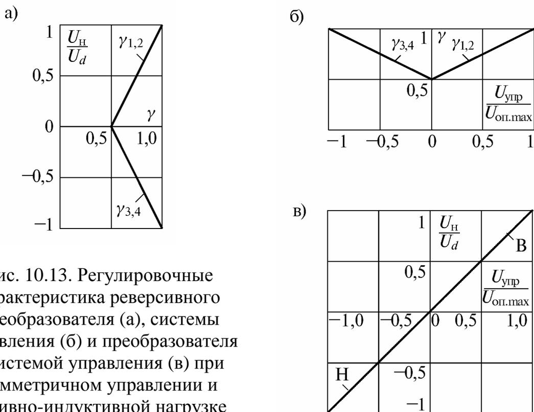
Рис. 10.13. Регулировочные характеристика реверсивного преобразователя (а), системы управления (б) и преобразователя с системой управления (в) при симметричном управлении и активно-индуктивной нагрузке
