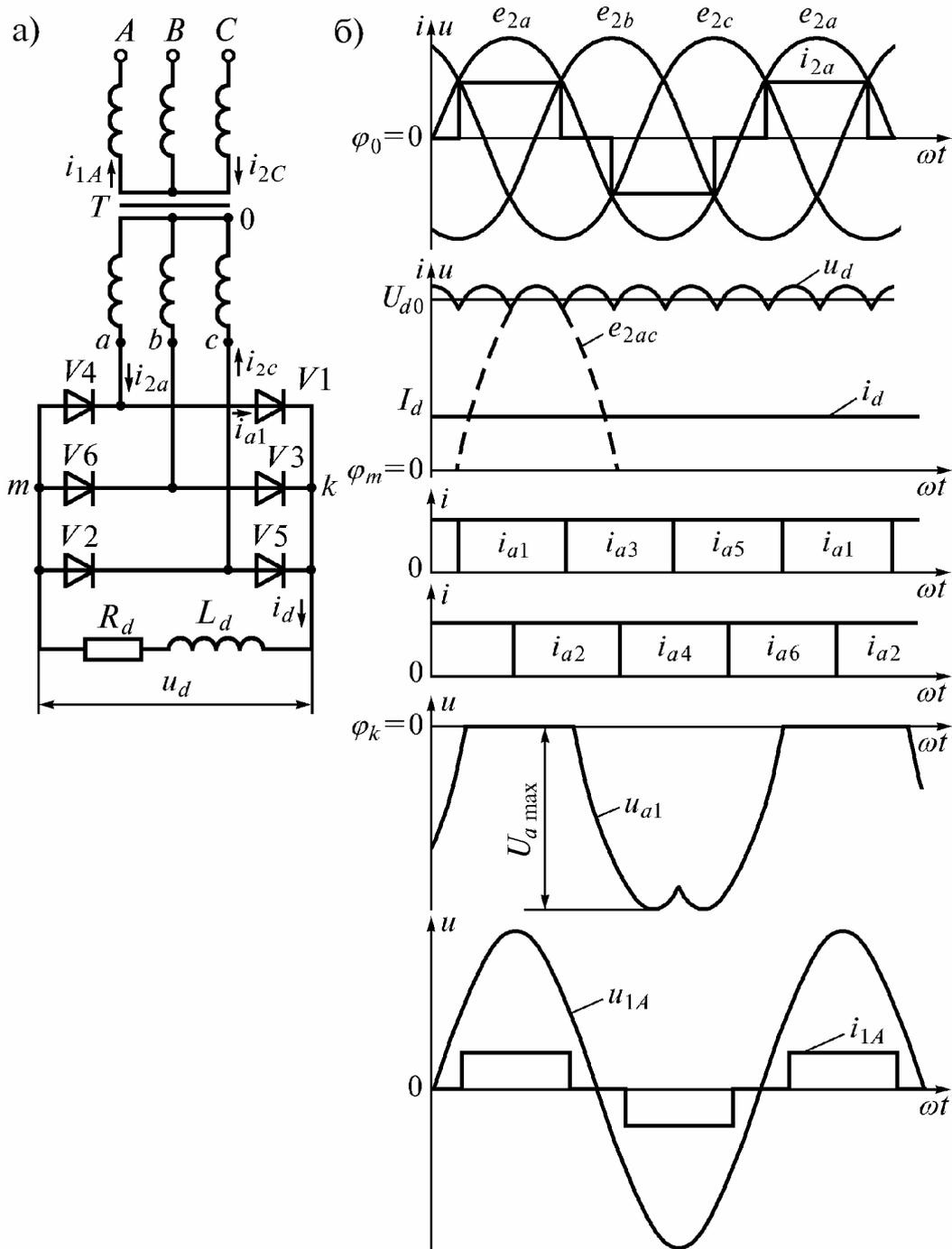
Рис. 4.13. Трехфазная мостовая схема выпрямления (схема Ларионова) (а) и диаграммы токов и напряжений, иллюстрирующие ее работу при  $L_d = \infty$  (б)
