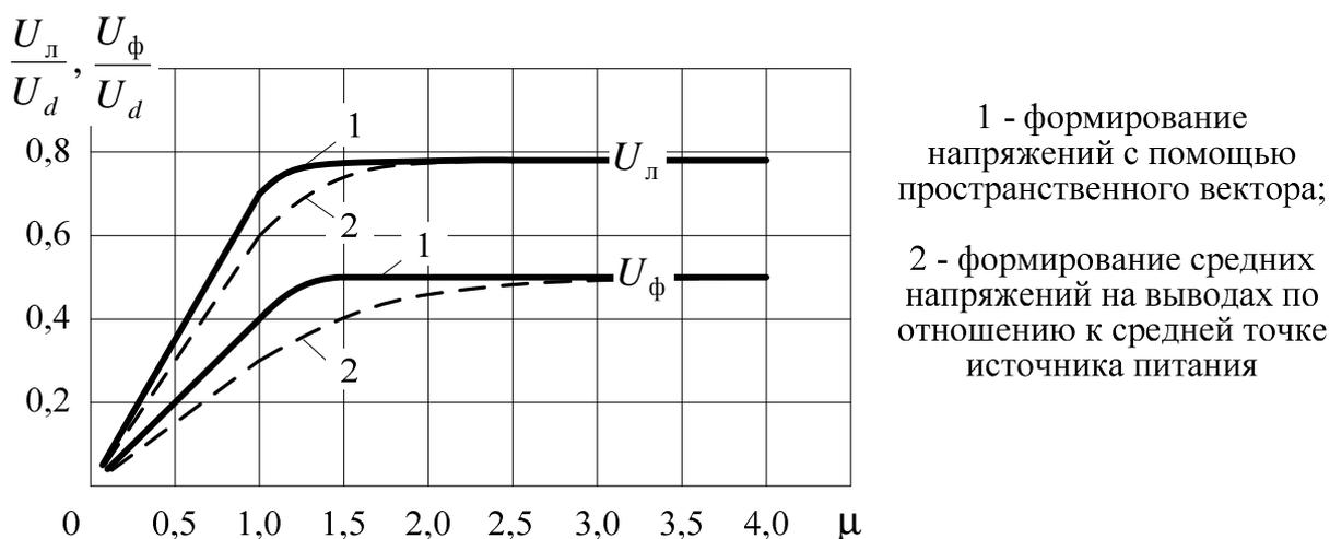
Рис. 11.30. Полные регулировочные характеристики с учетом зоны «сверхмодуляции»
