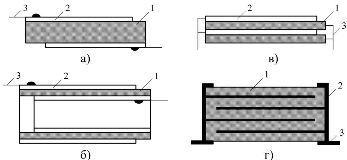
Рис. 2.39. Типы конструкции конденсаторов:
