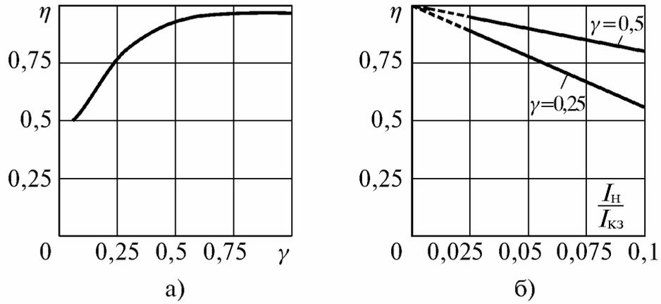
Рис. 10.8. Зависимости КПД ППН от  $\gamma$  (а) и тока  $I_H$  (б)
