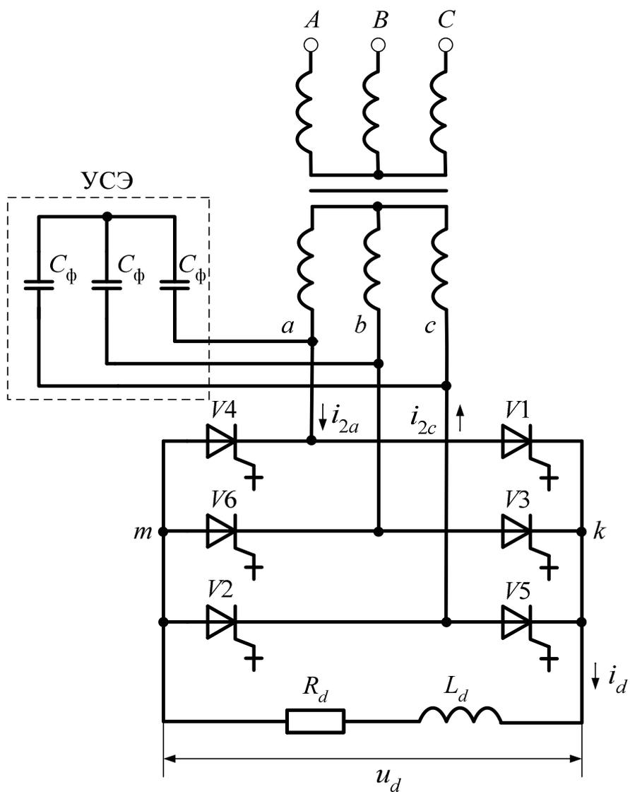
Рис. 6.11. Трехфазная мостовая схема на запираемых тиристорах
