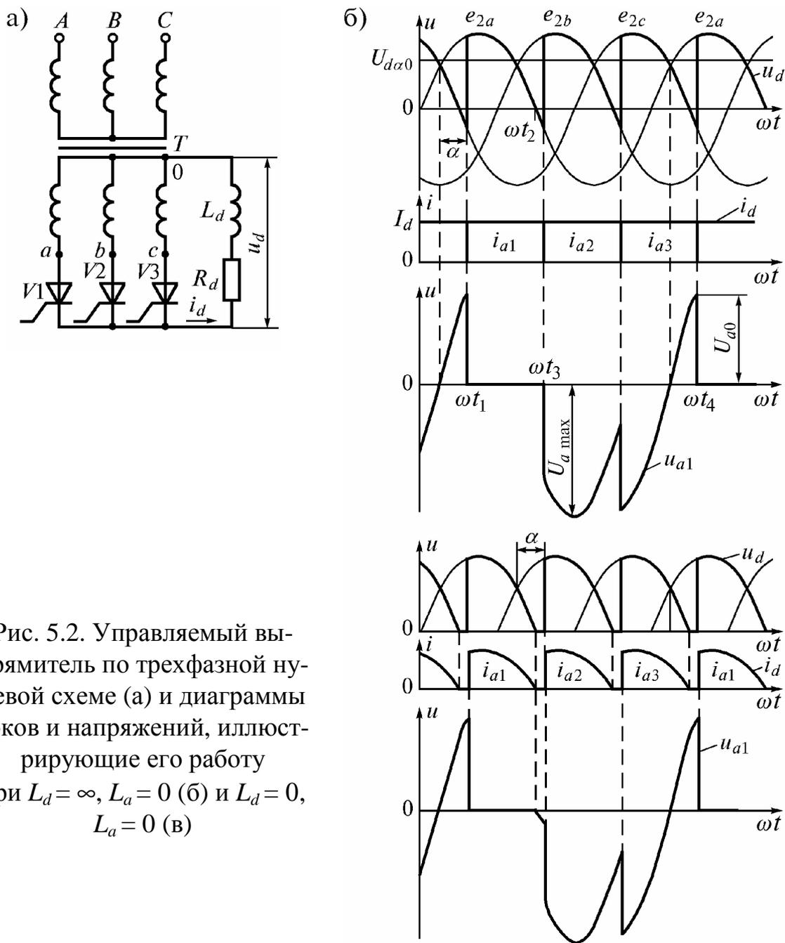
Рис. 5.2. Управляемый выпрямитель по трехфазной нулевой схеме (а) и диаграммы токов и напряжений, иллюстрирующие его работу при  $L_d = \infty, L_a = 0$  (б) и  $L_d = 0, L_a = 0$  (в)
