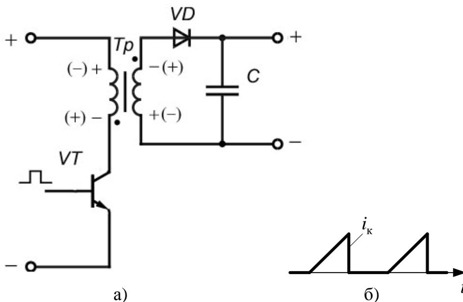
Рис. 17.5. ППН на базе однопulse инвертора напряжения с обратным включением диода (а) и диаграмма тока коллектора (б)
