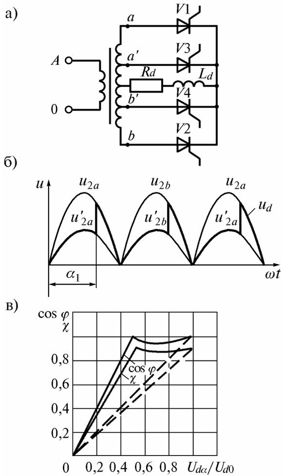
Рис.6.7. Однофазная нулевая схема с фазоступенчатым регулированием выпрямленного напряжения (а), диаграммы выпрямленного напряжения при  $\alpha_2 = 0$  (б) и энергетические показатели в функции глубины регулирования (в) при  $L_d = \infty$  (штриховые кривые соответствуют обычной однофазной нулевой схеме)
