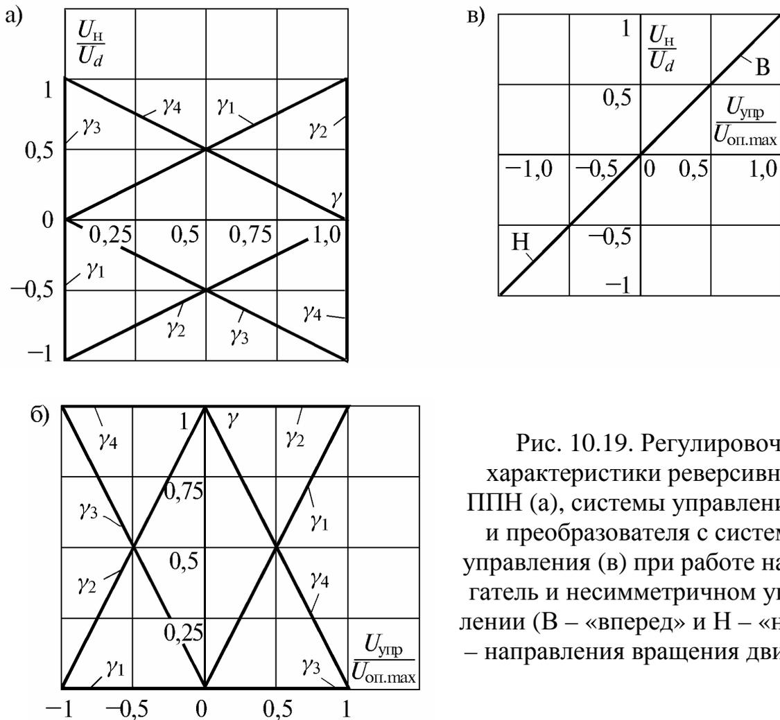
Рис. 10.19. Регулировочные характеристики реверсивного ППН (а), системы управления (б) и преобразователя с системой управления (в) при работе на двигатель и несимметричном управлении (В – «вперед» и Н – «назад» – направления вращения двигателя)
