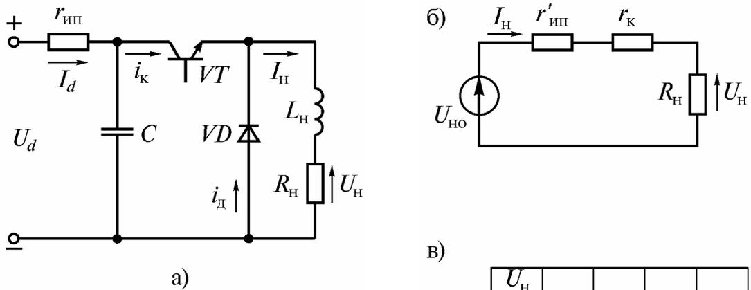
Рис. 10.9. Схема замещения (а) и эквивалентная схема ППН (б), а также его внешние характеристики (в) с учетом внутреннего сопротивления источника питания
