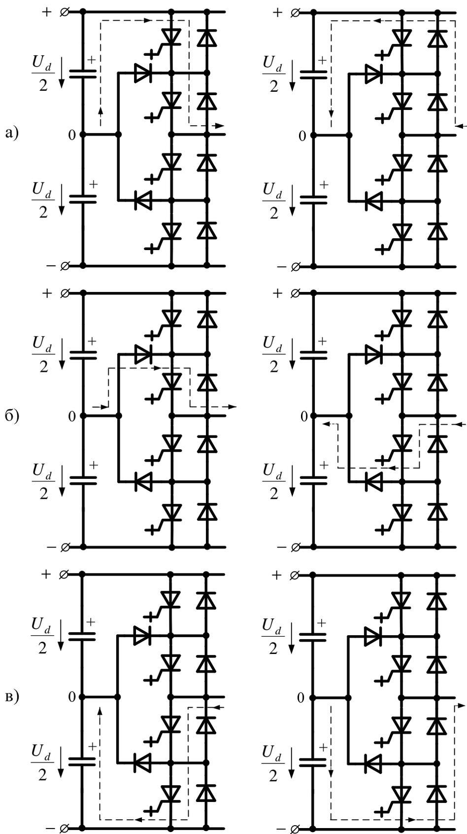
Рис. 11.27. Схемы прохождения тока через вентили одной фазы:
