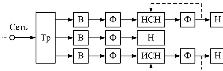
Рис. 17.1. Функциональная схема трансформаторного ИВЭП
