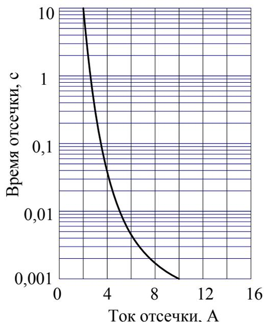
Рис. 2.50. Зависимость времени срабатывания от тока перегрузки
