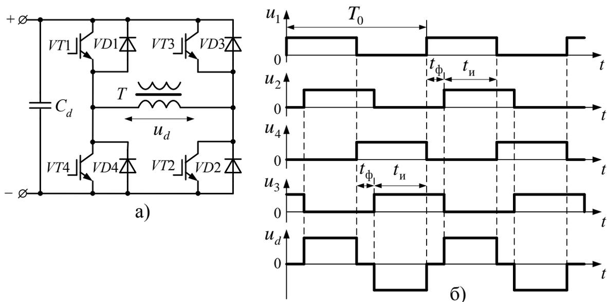
Рис. 19.3. Схема преобразователя мостового типа (а) и временные диаграммы импульсов управления транзисторами при фазо-импульсной модуляции (б) ( $u_1 \dots u_4$  – сигналы управления транзисторами  $VT1 \dots VT4$  соответственно)
