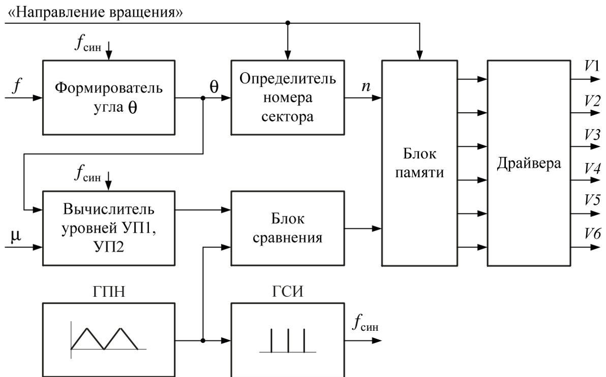
Рис. 11.22. Функциональная схема микропроцессорной системы управления векторной ШИМ
