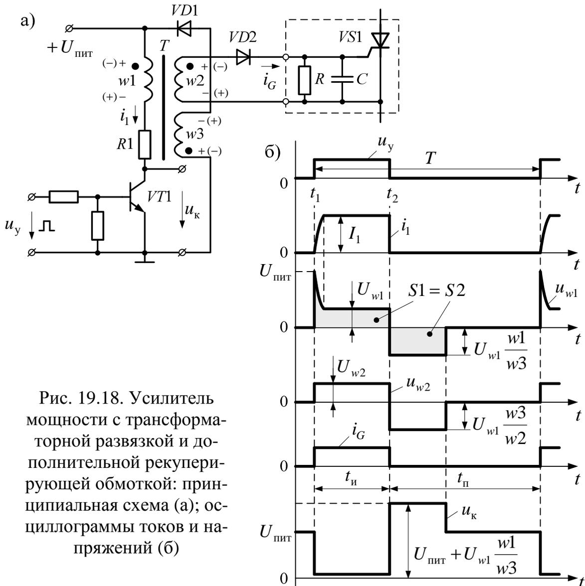
Рис. 19.18. Усилитель мощности с трансформаторной развязкой и дополнительной рекуперирующей обмоткой: принципиальная схема (а); осциллограммы токов и напряжений (б)
