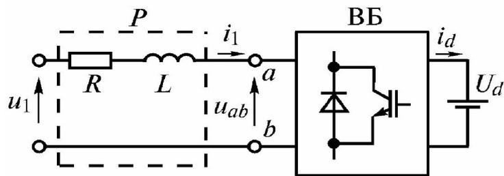
Рис. 12.9. Схема замещения однофазного ОПН
