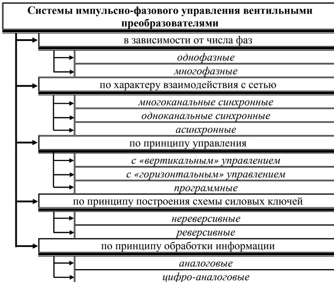
Рис. 9.1. Классификация систем импульсно-фазового управления вентильными преобразователями
