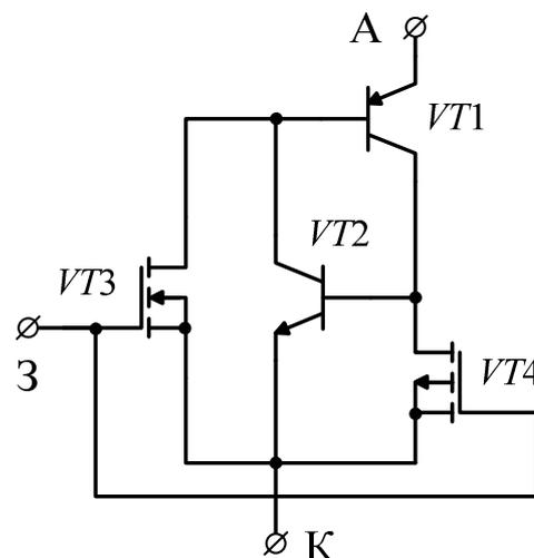
Рис. 2.15. Эквивалентная схема  $n$ -канального полевого тиристора  $MCT$
