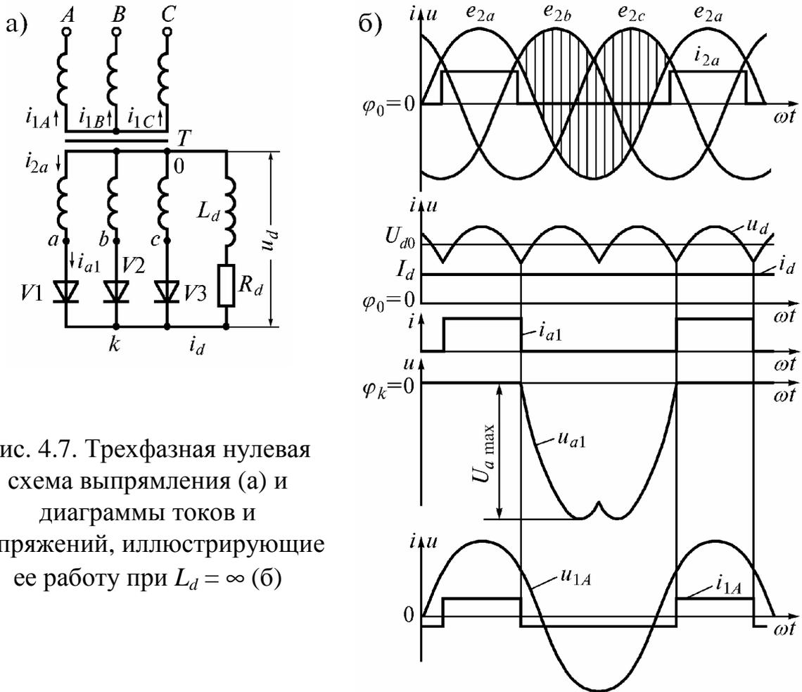
Рис. 4.7. Трехфазная нулевая схема выпрямления (а) и диаграммы токов и напряжений, иллюстрирующие ее работу при  $L_d = \infty$  (б)
