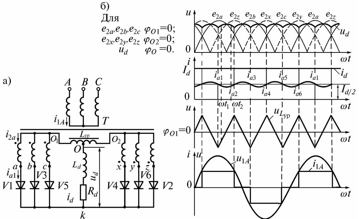
Рис. 4.12. Выпрямитель по схеме двойная звезда с уравнивающим реактором (а) и диаграммы токов и напряжений, иллюстрирующие его работу при  $L_d = \infty$  (б)
