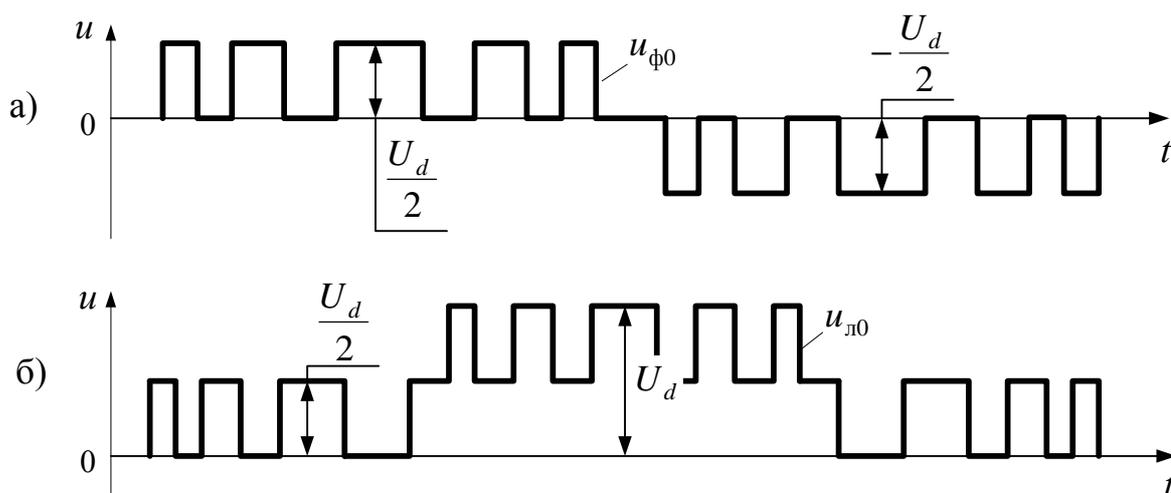
Рис. 11.28. Форма фазного напряжения  $u_{\phi 0}$  (а) и линейного напряжения  $u_{\lambda 0}$  (б) многоуровневого АИН при ШИМ по синусоидальному закону
