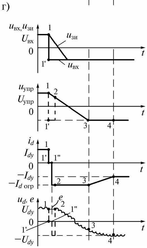
Рис. 9.19. Переходные процессы при реверсе тока в цепи якоря двигателя (активно-индуктивная нагрузка с ПЭДС при  $L_d$  близком к нулю) при совместном (а, б) и раздельном управлении (в, г). Штриховой линией показаны участки переходных процессов при отсутствии задатчика интенсивности
