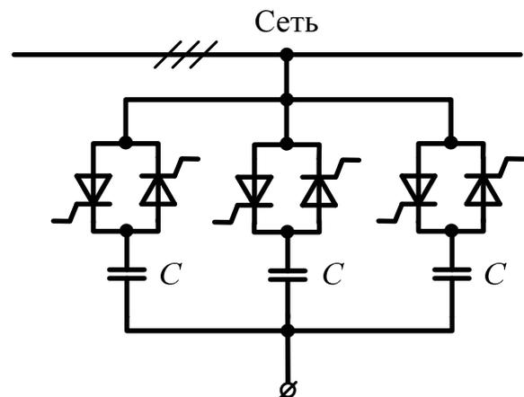
Рис. 18.2. Схема для управления БК тиристоров
