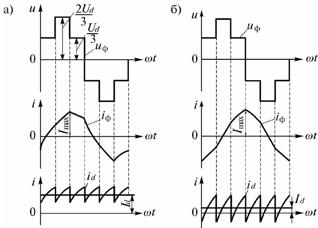
Рис. 11.12. Диаграммы напряжений и токов в трехфазном мостовом автономном инверторе напряжения при угле проводимости вентилей 180 эл.град и различных коэффициентах мощности нагрузки: а)  $\chi > 0,528$ ; б)  $\chi < 0,528$
