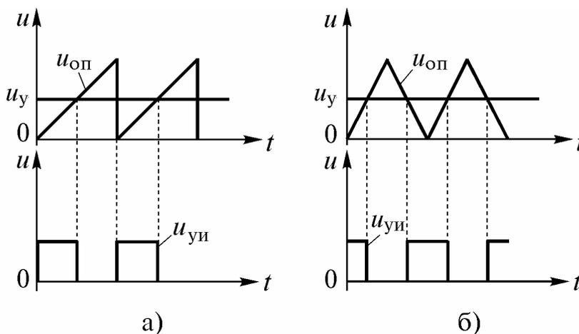
Рис. 11.14. Фронтая (а) и центрированная (б) ШИМ
