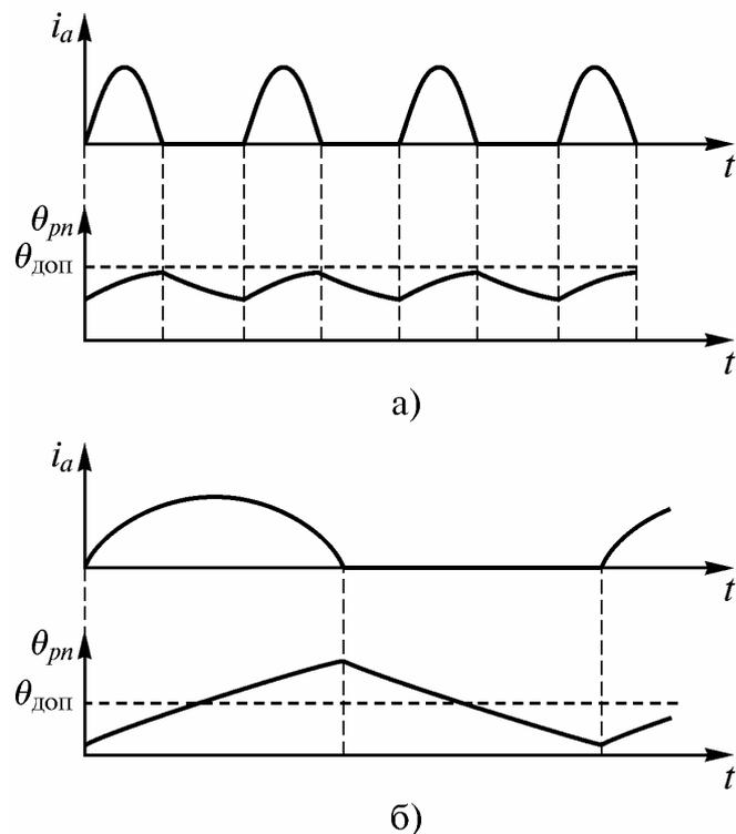
Рис. 2.11. Диаграммы тока и температуры кристалла при  $f = 50$  Гц (а) и при  $f = 1$  Гц (б)
