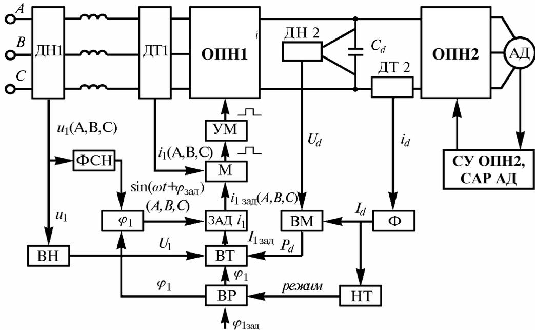
Рис. 13.6. Функциональная схема рекуперирующего ДПЧ с регулируемым коэффициентом мощности
