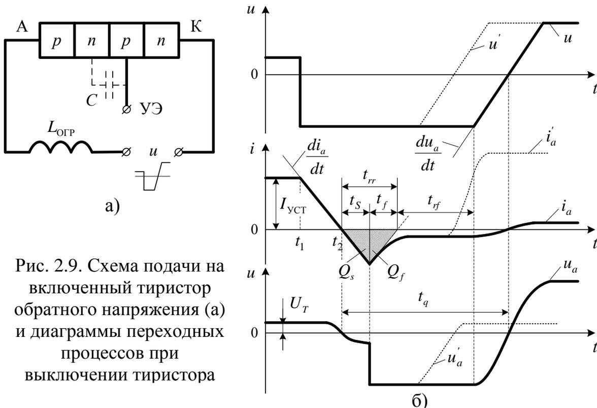
Рис. 2.9. Схема подачи на включенный тиристор обратного напряжения (а) и диаграммы переходных процессов при выключении тиристора
