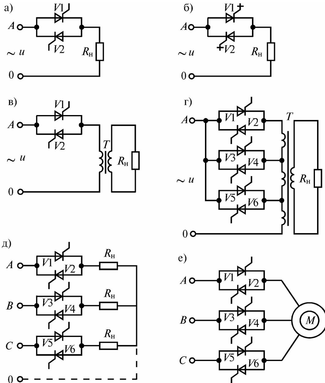
Рис. 14.1. Преобразователи переменного напряжения: однофазные на неполнотью (а) и полностью управляемых (б) тиристорах; однофазные на первичной стороне трансформатора (в) и трансформатора с отпайками (г); трехфазные для регулирования напряжения на активной нагрузке (д) и двигателе (е)
