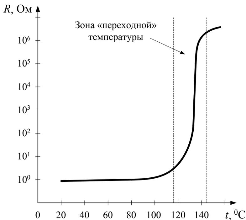
Рис. 2.49. Зависимость сопротивления самовосстанавливающегося предохранителя от температуры полимера
