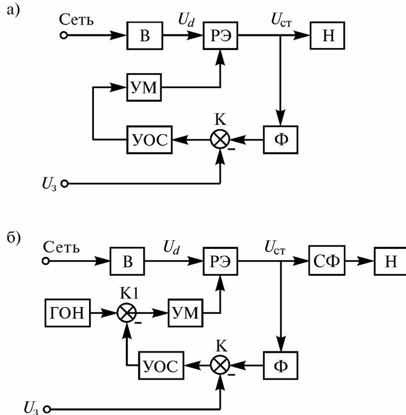
Рис. 16.2. Схемы непрерывного (а) и импульсного (б) стабилизаторов напряжения
