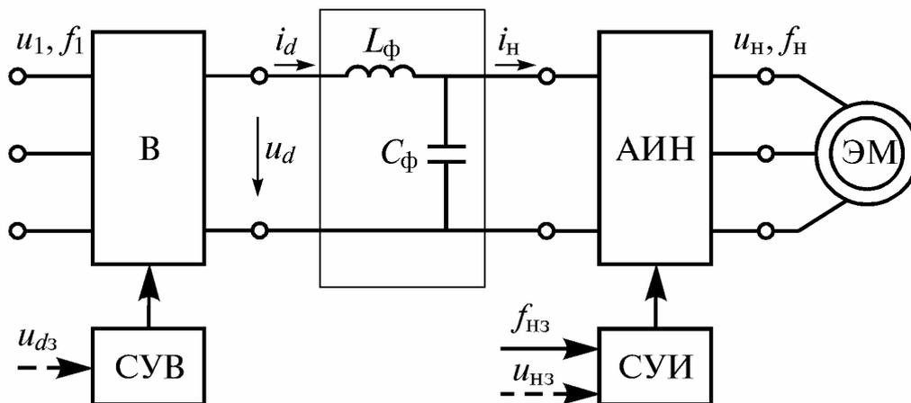
Рис. 13.1. Функциональная схема двухзвенного преобразователя частоты на основе АИН, работающего на двигатель переменного тока (В – выпрямитель; Ф – фильтр; АИН – автономный инвертор напряжения; ЭМ – электрическая машина; СУВ, СУИ – системы управления выпрямителем и автономным инвертором. Штриховой линией показаны воздействия и связи, которые могут отсутствовать)
