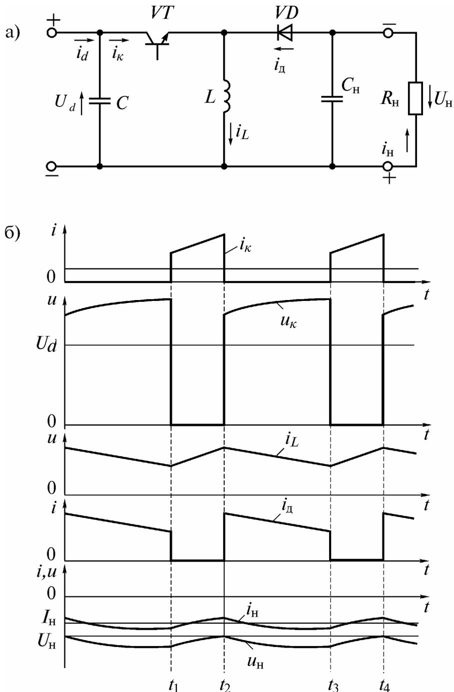
Рис. 10.4. Схема инвертирующего ППН (а) и диаграммы напряжений и токов, иллюстрирующие его работу (б)
