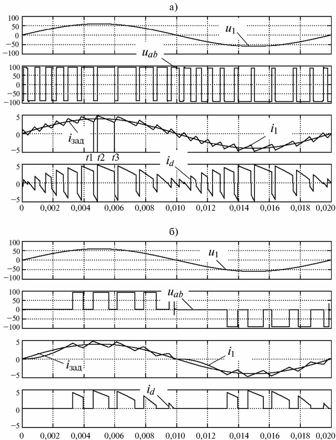
Рис. 12.4. Осциллограммы токов и напряжений в однофазной мостовой схеме при симметричном (а) и несимметричном (б) управлении
