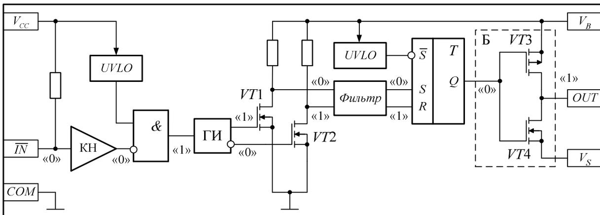
Рис. 19.26. Структурная схема драйвера верхнего ключа мостовой схемы  $IR2118$ :  $V_{CC}$  – напряжение питания драйвера;  $COM$  – отрицательный полюс источника
