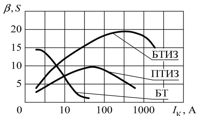
Рис. 2.33. Зависимость усилительных свойств транзисторов от тока
