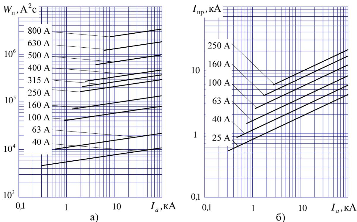
Рис. 2.48. Зависимости полного интеграла отключения  $W_n$  (а) и предельного тока, ограниченного предохранителем  $I_{пр}$  (б) от действующего значения первой полуолны ТКЗ
