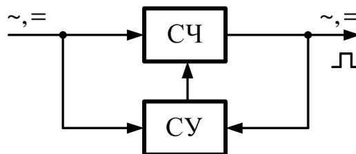
Рис. 1.2. Состав устройства преобразовательной техники (СЧ – силовая часть; СУ – система управления)
