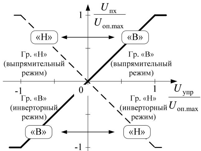
Рис. 9.15. Статическая характеристика «вход – выход» переключателя характеристик прямого канала регулирования реверсивного ТП
