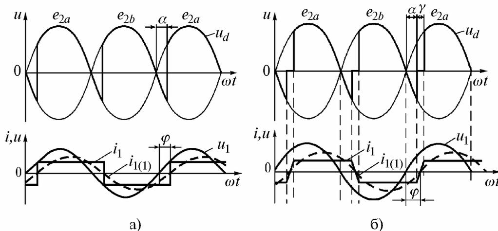
Рис. 6.3. Диаграммы напряжений и токов в управляемом выпрямителе по однофазной нулевой схеме с естественной коммутацией при  $\alpha = 30^\circ$  для случая  $L_d = \infty$ ,  $L_a = 0$  (а) и  $L_a \neq 0$  (б)
