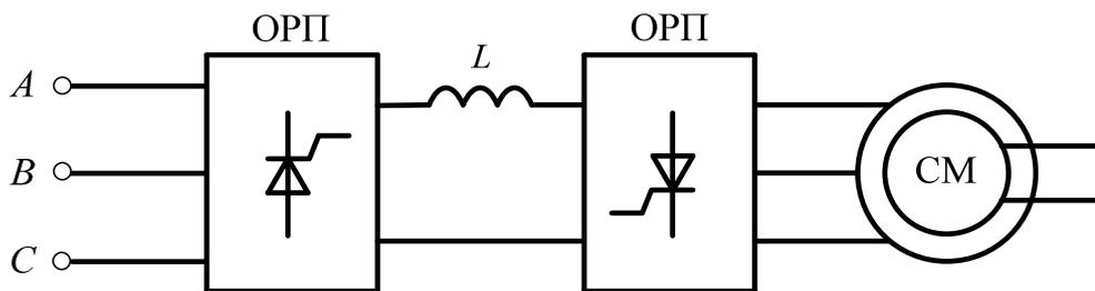
Рис. 13.10. Двухзвенный преобразователь частоты на основе ведомых преобразователей
