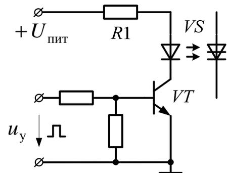
Рис. 19.20. Схема включения управляющей цепи оптотиристора
