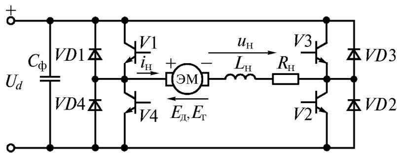
Рис. 10.15. Схема реверсивного ППН, работающего на якорь двигателя
