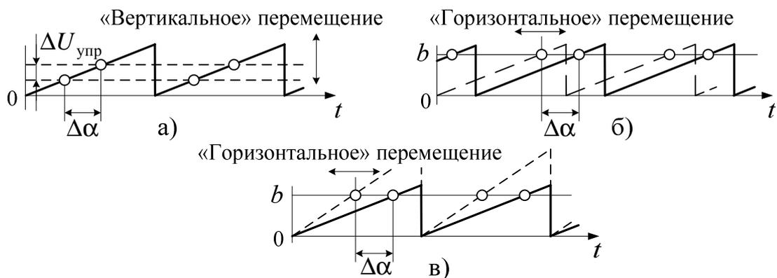
Рис. 9.8. Временные диаграммы сигналов при «вертикальном» (а) и «горизонтальном» (б, в) принципах управления СИФУ
