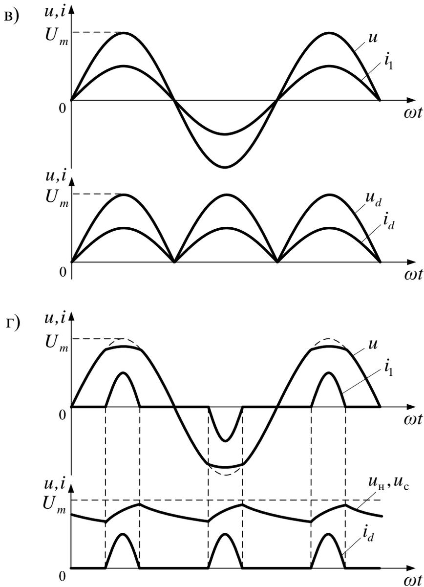
Рис. 17.9. Однофазные мостовые схемы с активной нагрузкой (а), с емкостным фильтром и активной нагрузкой (б), а также временные диаграммы токов и напряжений для этих схем (в, г)
