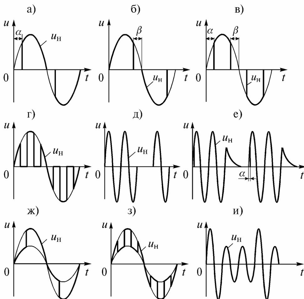
Рис. 14.2. Диаграммы напряжений на нагрузке ППН при различных способах управления (модуляции): ИМ–ОЧ (фазовое регулирование) с отстающим ( $\alpha > 0$ ), опережающим ( $\beta > 0$ ) и равным нулю ( $\alpha = \beta$ ) углом сдвига  $\varphi$  (а, б, в); ИМ–ВЧ (г); ИМ–НЧ (д); ИМ–НЧ на первичной стороне трансформатора (е); многозонные ИМ–ОЧ (ж), ИМ–ВЧ (з) и ИМ–НЧ (и)
