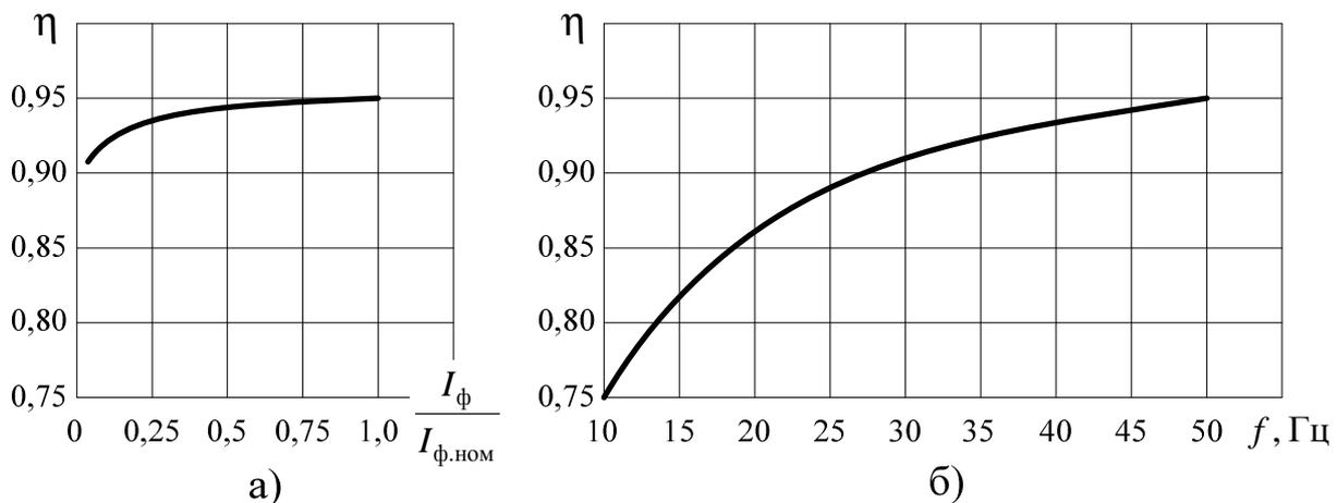
Рис. 11.33. Зависимости КПД от тока (а) и частоты при выполнении закона  $U/f = \text{const}$  (б)
