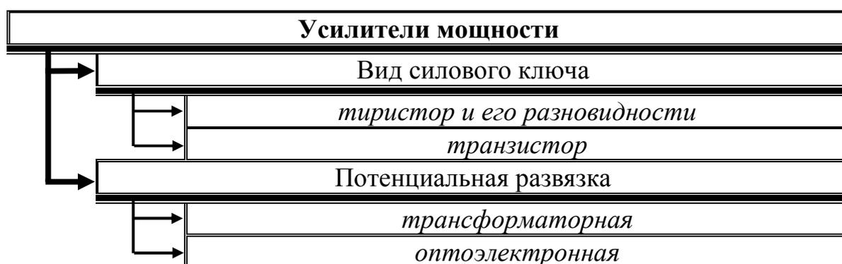
Рис. 19.15. Классификация усилителей мощности импульсов управления
