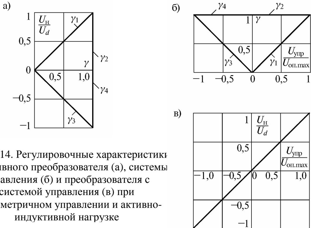
Рис. 10.14. Регулировочные характеристики реверсивного преобразователя (а), системы управления (б) и преобразователя с системой управления (в) при несимметричном управлении и активно-индуктивной нагрузке
