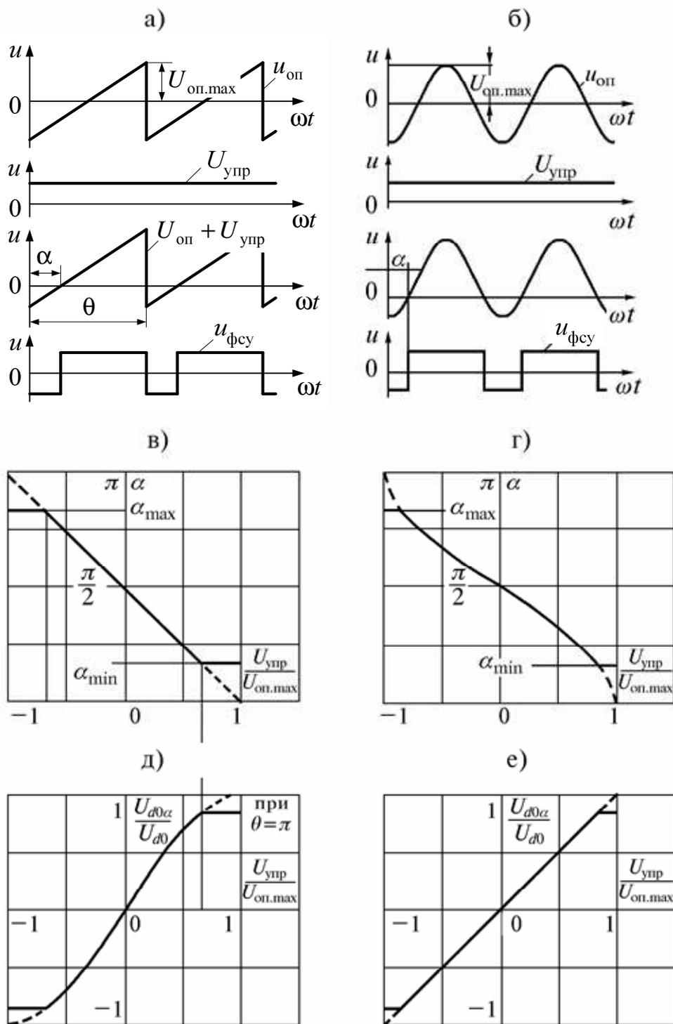
Рис. 9.13. Диаграммы напряжений (а, б), регулировочные характеристики СИФУ (в, г) и регулировочные характеристики всего преобразователя вместе с СИФУ (д, е) при линейном и косинусоидальном опорном напряжении
