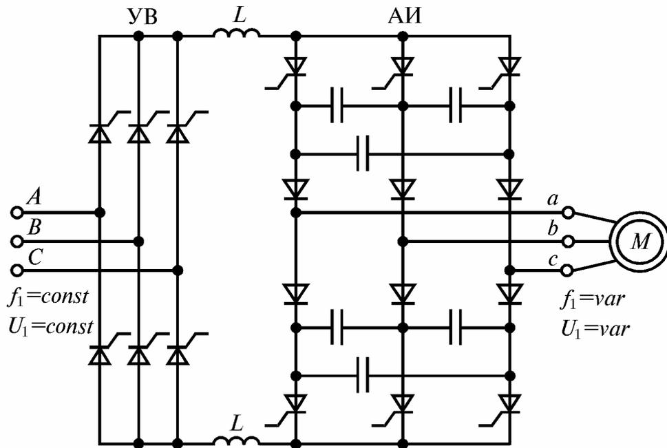
Рис. 13.7. ДПЧ на основе АИТ с отсекающими диодами
