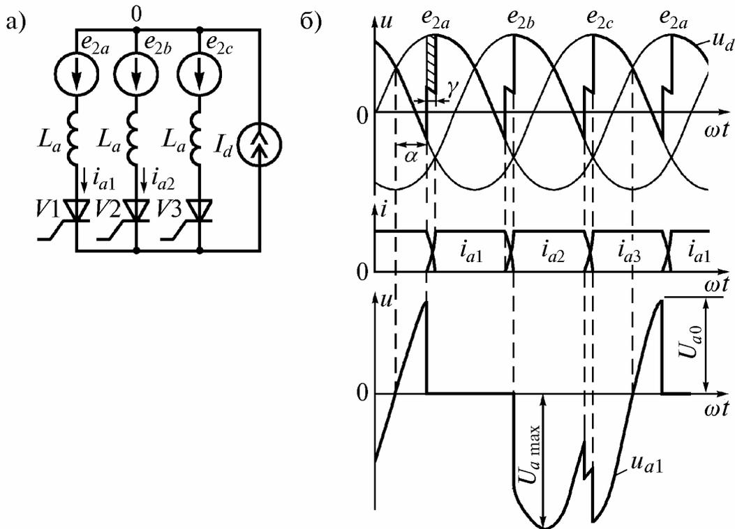
Рис. 5.4. Схема замещения управляемого выпрямителя, выполненного по трехфазной схеме с нулевым выводом, при допущении  $L_d = \infty$ ,  $L_a \neq 0$ ,  $r_a = 0$  (а) и диаграммы токов и напряжений, иллюстрирующие его работу (б)
