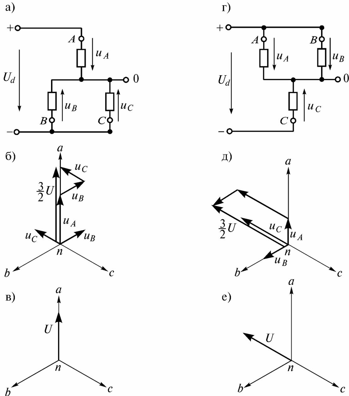
Рис. 11.20. Иллюстрация понятия обобщенный вектор: схема соединений при включении вентилей  $V_6, V_1, V_2$  (а); построение обобщенного вектора (б); обобщенный вектор для этого случая (в); схема соединений при включении вентилей  $V_1, V_2, V_3$  (г); построение обобщенного вектора (д) и обобщенный вектор для этого случая (е)
