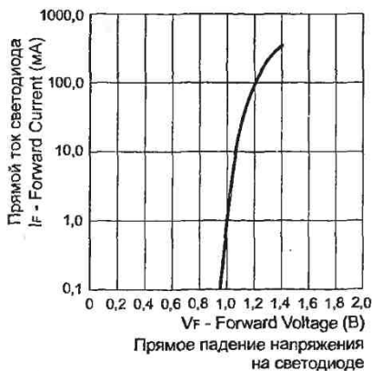
Рис. 14.39. График зависимости падения прямого напряжения от протекающего прямого тока для светоизлучающего диода оптопары 4N25
