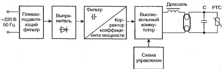
Рис. 15.3. Типовая схема электронного балласта
