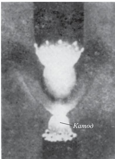
Рис. 300. Фотография дугового разряда между угольными электродами при атмосферном давлении
