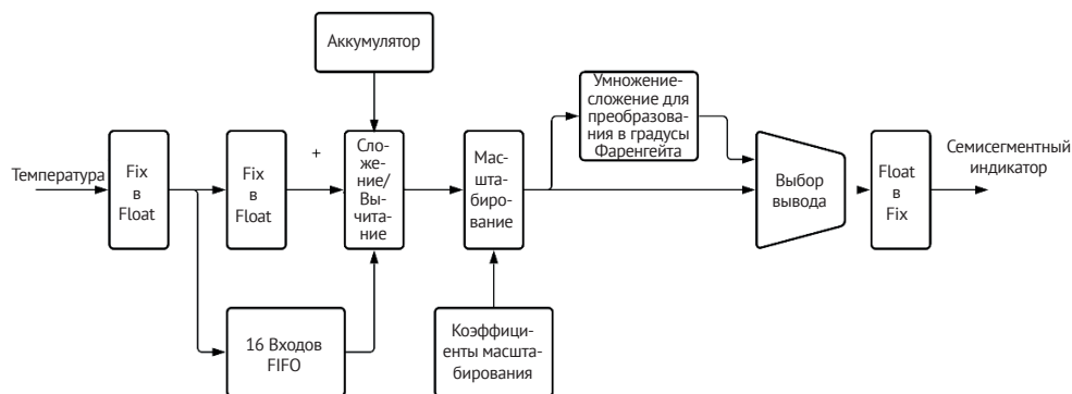
Рис. 7.2. Оригинальный конвейер для датчика температуры
