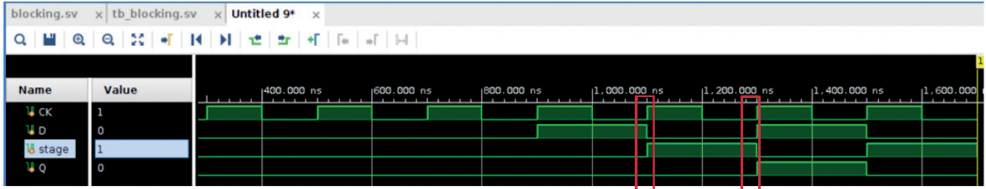
Рис. 3.8. Моделирование неблокирующих присваиваний в блоке always, реализующем последовательную логику
