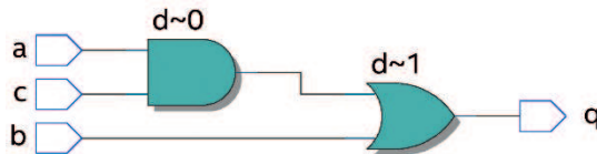
Рис. 2.19 Пример блокирующего присваивания: сгенерированная RTL-схема
