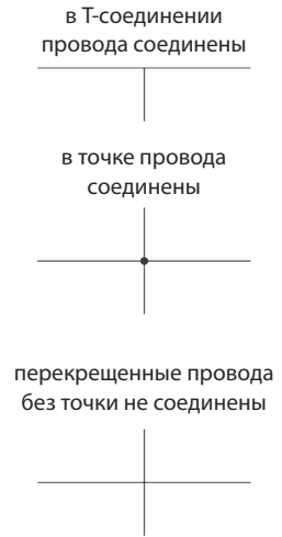
Рис. 2.24. Способы соединения проводников
