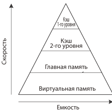
Рис. 8.16. Иерархия памяти с двумя уровнями кэша
