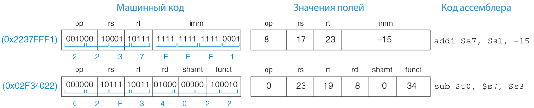
Рис. 6.12. Трансляция машинного кода на язык ассемблера
