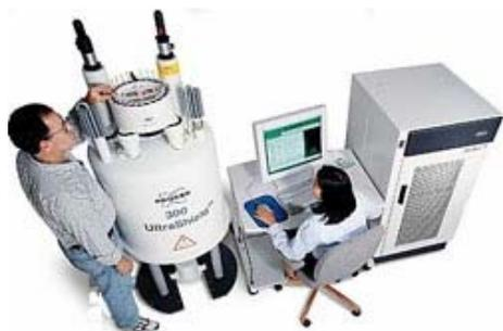
Магнитное поле, в котором находится исследуемый образец, в этих приборах постоянно. Как правило, используют очень сильные поля, создаваемые сверхпроводящими магнитами (чем и обусловлена высокая стоимость этих приборов). Образец подвергают не длительному непрерывному облучению, а воздействию кратковременного
