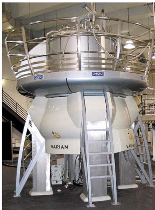
существенно сокращается время обычного эксперимента, а получаемый спектр становится существенно информативнее. На рисунках изображены 300 МГц спектрометр производства фирмы BRUKER и магнит 800 МГц спектрометра производства фирмы VARIAN.
