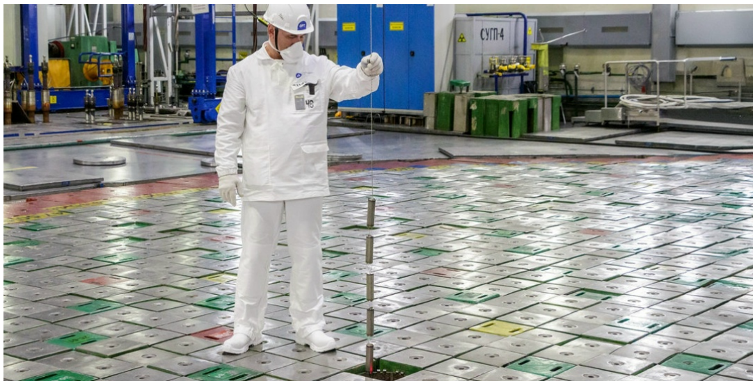
Работник САЭС достаёт из канала для наработки изотопов ампулы с изотопом, скорее всего кобальтом-60
