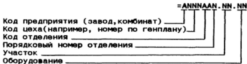
Например, =A102TK1.52.16 означает, что система вентиляции (16), участка обдирки (52) находится в отделении отделки ТК1 заготовительного стана (номер по генплану 102) на предприятии А.
