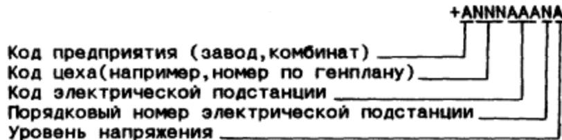
Например, =А114ЕТВ2К означает цеховую трансформаторную подстанцию ЕТВ номер 2 напряжением 10 кВ, расположенную в здании, имеющем номер на генплане 114 на предприятии А.
