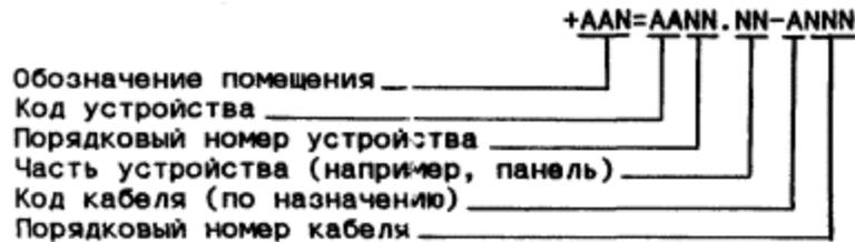
Например, +EE1=AC01.03-K104 означает, что контрольный кабель 104 подключается к третьей панели щита AC01, расположенному в первом электротехническом помещении.
