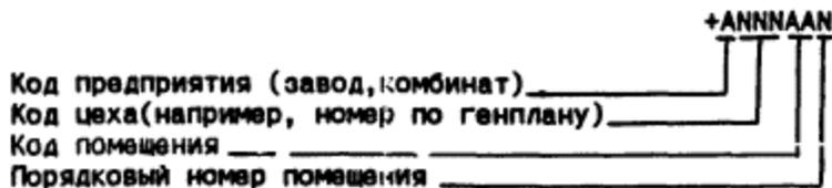
Например, +A114EE1 обозначает, что первое электротехническое помещение расположено в здании, имеющем номер на генплане 114 на предприятии А.
