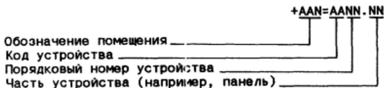
Например, +EE1=AC01.03 означает третью панель щита AC01, расположенного в первом электротехническом помещении.
