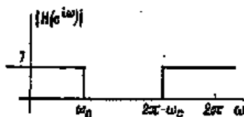
Рис.4.26. Частотная характеристика идеального фильтра нижних частот
