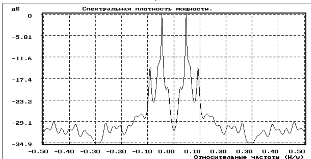
Рис.6.22. AP(40)-оценка СПМ фильтрованных и прореженных чисел солнечных пятен, полученная модифицированным ковариационным методом.
