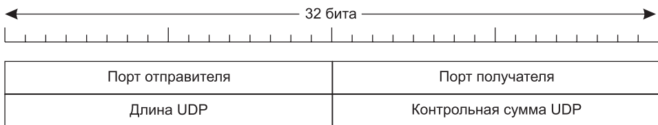
Рис. 6.23. Заголовок UDP
