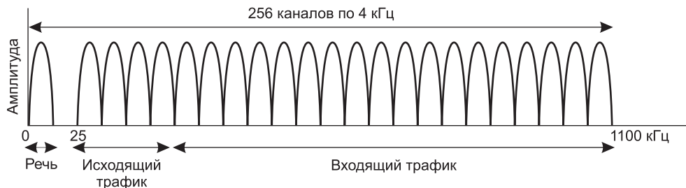
Рис. 2.30. Работа ADSL с использованием дискретной мультитональной модуляции
