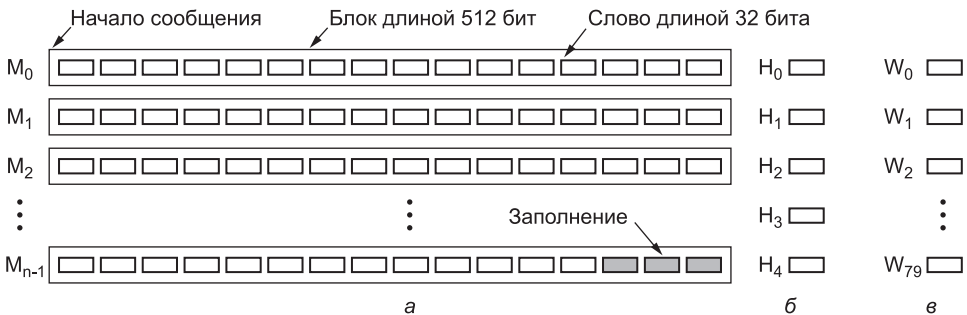
Рис. 8.19. Сообщение, дополненное до размера, кратного 512 битам ( а ); выходные переменные ( б ); массив слов ( в )
