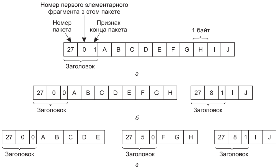
Рис. 5.38. Фрагментация при элементарном размере 1 байт: а — исходный пакет, содержащий 10 байт данных; б — фрагменты после прохождения через сеть с максимальным размером 8 байт; в — фрагменты после прохождения через шлюз размера 5
