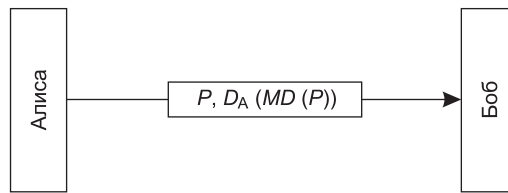
Рис. 8.17. Цифровая подпись с использованием профиля сообщения
