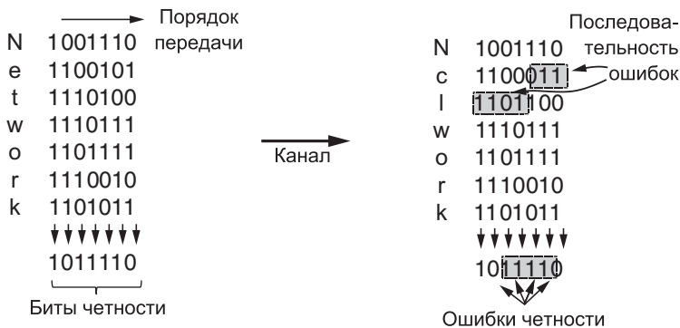
Рис. 3.8. Чередование битов четности для обнаружения последовательностей ошибок
