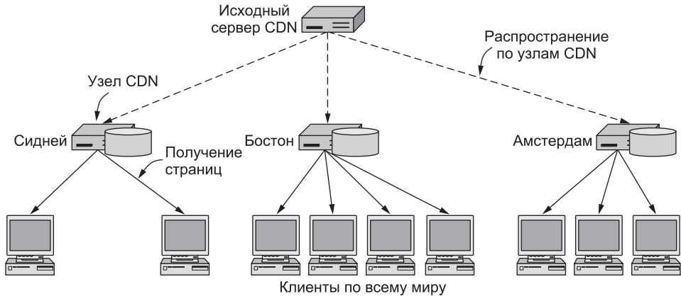
Рис. 7.40. Дерево распределения CDN
