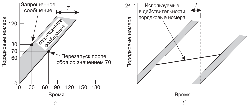
Рис. 6.7. Сегменты не могут заходить в запретную зону (а); проблема ресинхронизации (б)
