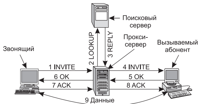
Рис. 7.36. Использование прокси-сервера и переадресации в протоколе SIP
