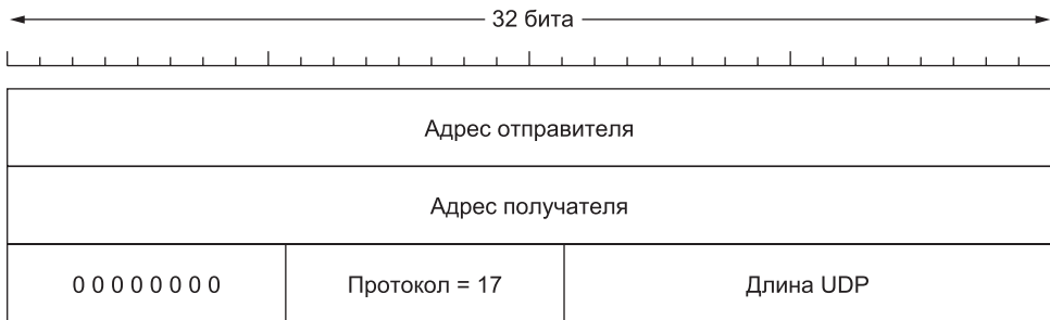
Рис. 6.24. Псевдозаголовок, включаемый в контрольную сумму UDP
