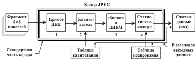
Рис. 6.6. Схема сжатия изображений по стандарту JPEG
