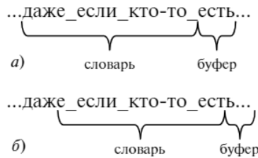
Рис. 5.17. Иллюстрация одного шага кодирования по методу LZ77
