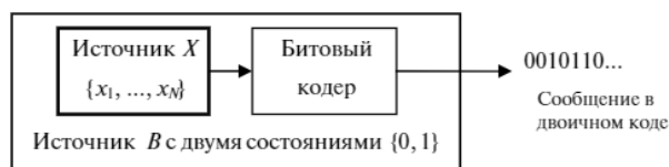
Рис. 5.8. Интерпретация битового кода как сообщения двоичного источника
