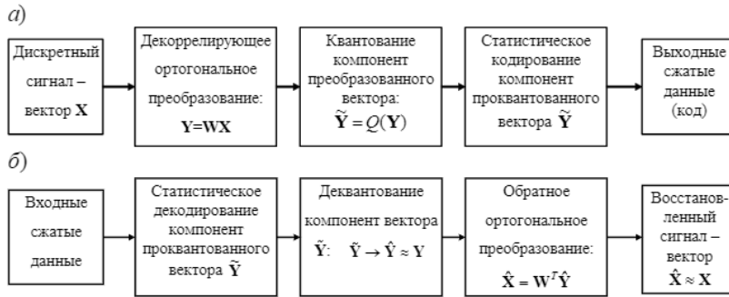
Рис. 6.1. Схема сжатия (а) и восстановления (б) коррелированных данных с использованием ортогонального преобразования
