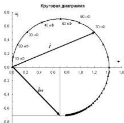
Рис. 4.15. Определение I_{кз} и тока при C = 70 нФ по круговой диаграмме
