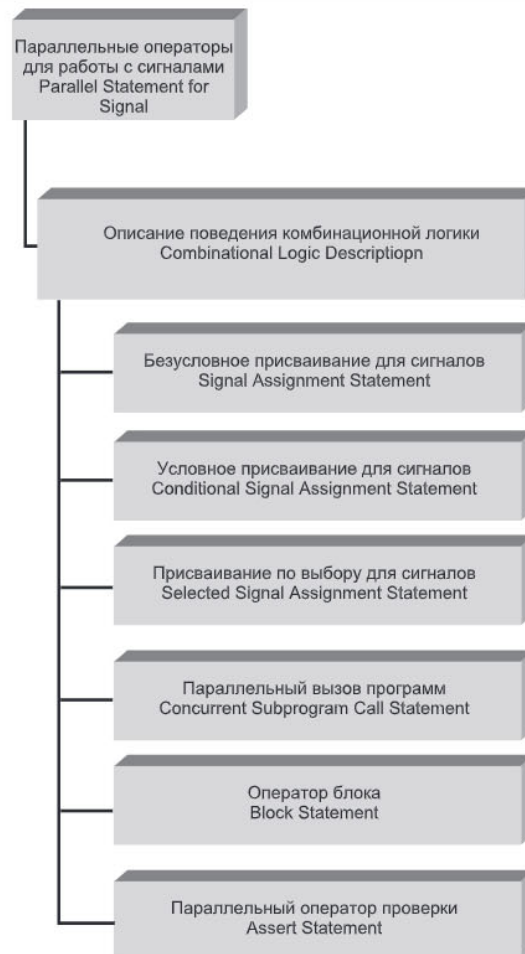
Рис. 3.1,б. Ресурсы VHDL для описания проектируемых систем во времени. Параллельные операторы для работы с сигналами
