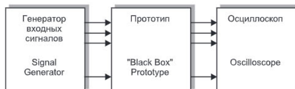
Рис. 1.1. Верификация с прототипом в виде «черного ящика» (Verification with «block box» prototype)
