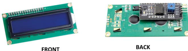
Рис.5.27: Стандартный ЖК-дисплей на базе I2C.
