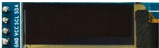
Рис. 9.1: 0,91-дюймовый OLED-дисплей.
