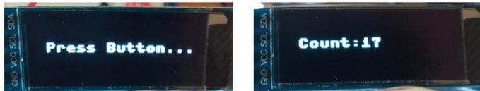
Рис.9.17: Дисплей до и после нажатия кнопки.
