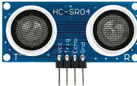
Рис.5.41: Модуль ультразвукового датчика HC-SR04.
