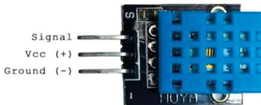
Рис. 7.20: Датчик температуры и влажности DHT11.
