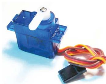
Рис.12.2: Сервопривод для использования в моделировании.
