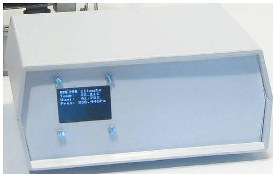
Рисунок 16.3: Компактная метеостанция WLAN с дисплеем.
