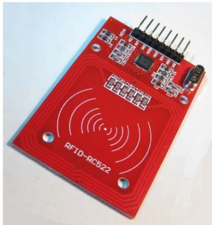
Рис.13.1: Модуль RFID.
