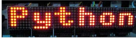
Рис. 11.4: Точечный матричный дисплей с шестью матричными элементами 8 x 8.
