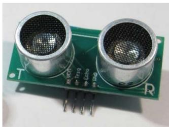
Рис.9.18: Ультразвуковой модуль с двумя преобразователями.
