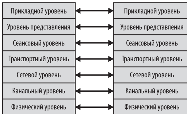
Рис. 2.3. Модель OSI, демонстрирующая взаимодействия между системами
