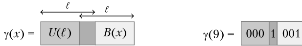
Рис. 11.1. Графическое представление: слева — \gamma(x) при x > 0 и \ell = |B(x)| , темно-серый прямоугольник обозначает двоичную цифру 1, общую для U(\ell) и B(x) ; справа — \gamma(9) . Обратите внимание на темно-серую цифру 1, общую для унарного кода U(4) и двоичного кода B(9)
