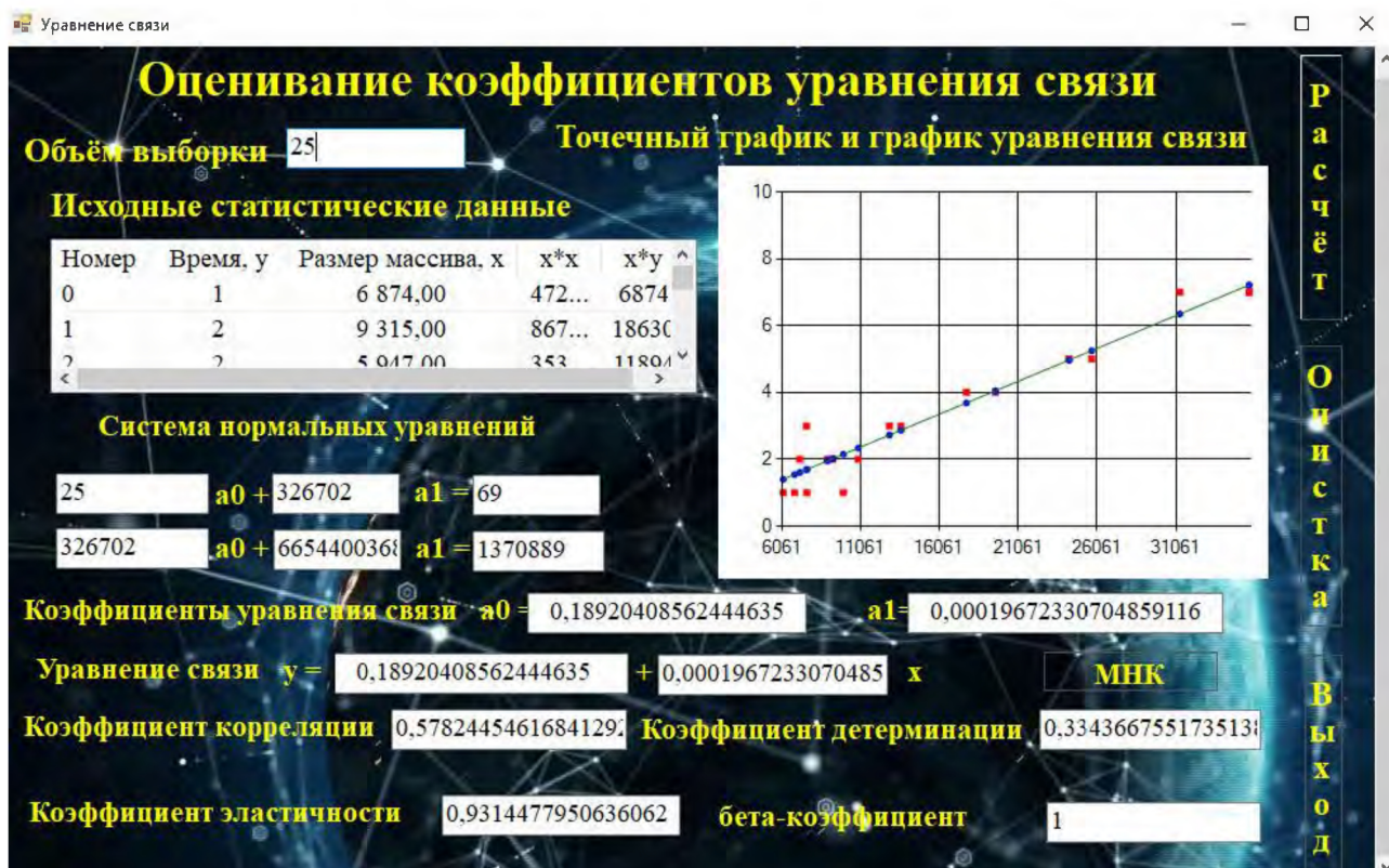
Рисунок 8.9 – Оценивание коэффициентов уравнения связи между временным и ёмкостным параметрами программного алгоритма
