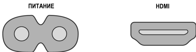
Рис. 1.4. Разъемы на задней панели телевизора намеренно имеют разную форму, чтобы затруднить подключение неправильных кабелей в неправильные отверстия
